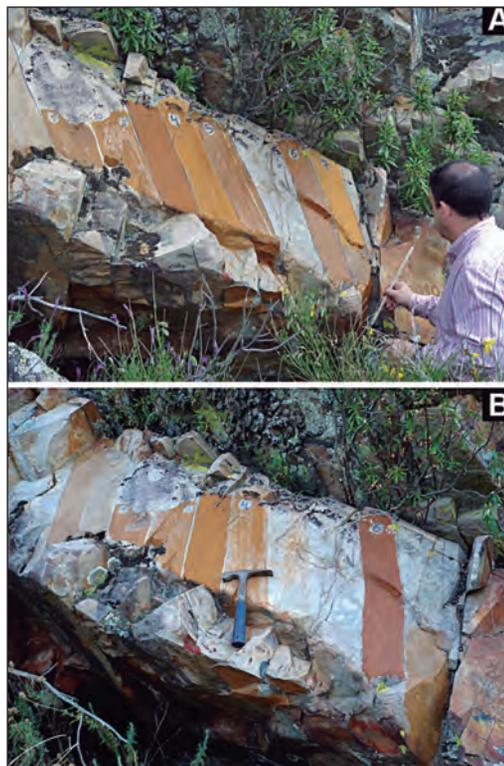
**Figura 9.** Ensayo de pátinas protectoras coloreadas en un banco de cuarcita (A), y resultado del test al cabo de 15 meses (B). La prueba número 3 superó la prueba en mejores condiciones de estabilidad frente a los elementos y reversibilidad opcional.
