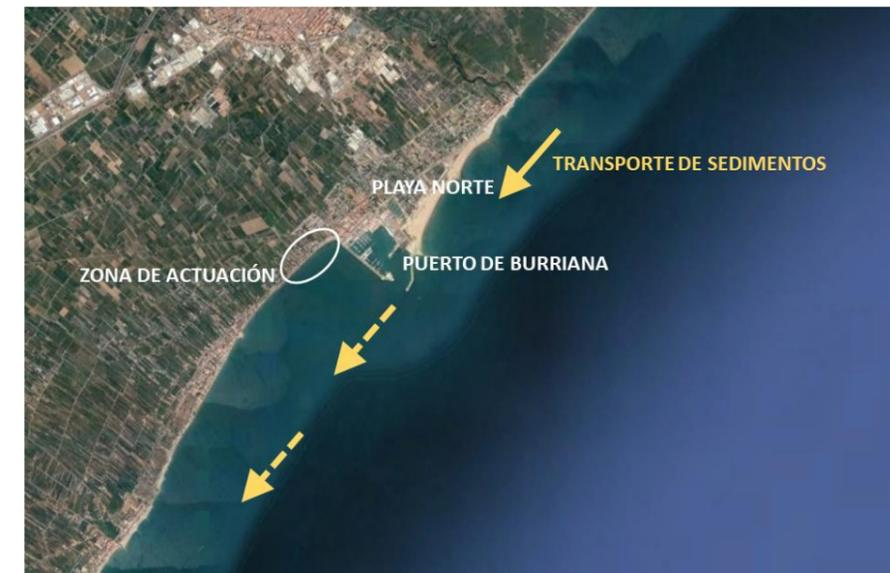
Vista en planta del emplazamiento. Dirección y sentido del transporte longitudinal de sedimentos.
