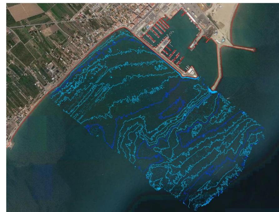
Figura 2. Vista de la batimetría y línea de costa de detalle, realizada hasta la profundidad 10 m.
