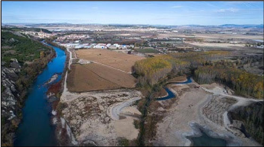
*Imagen 20. Recuperación de la llanura de inundación y apertura de la salida del antiguo meandro.*
