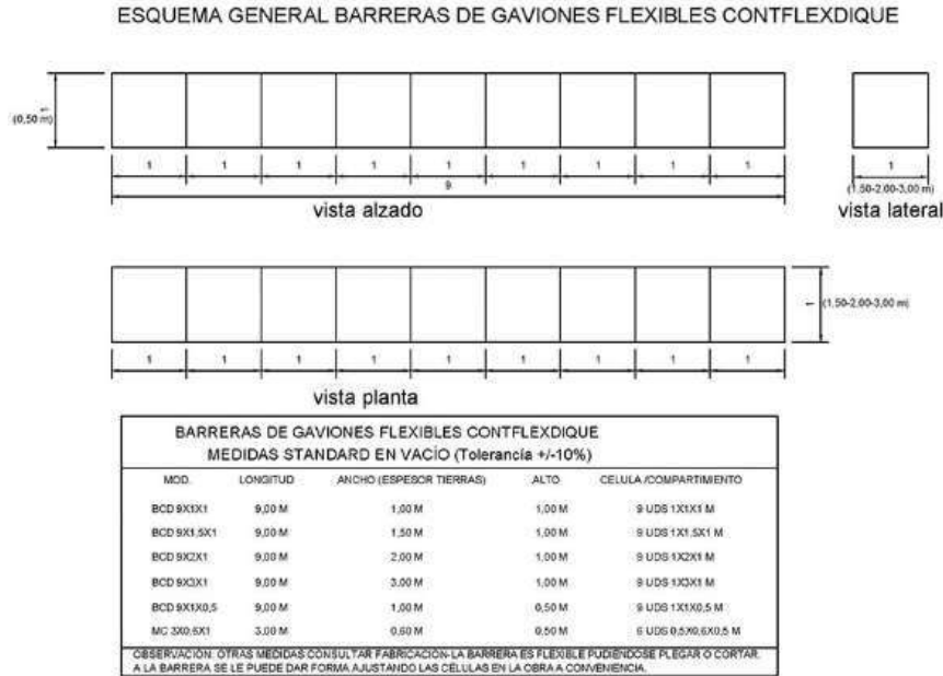
Figura 1: Barrera gaviones. Fuente: Contflexdique.[Consulta: Oct-2022]
