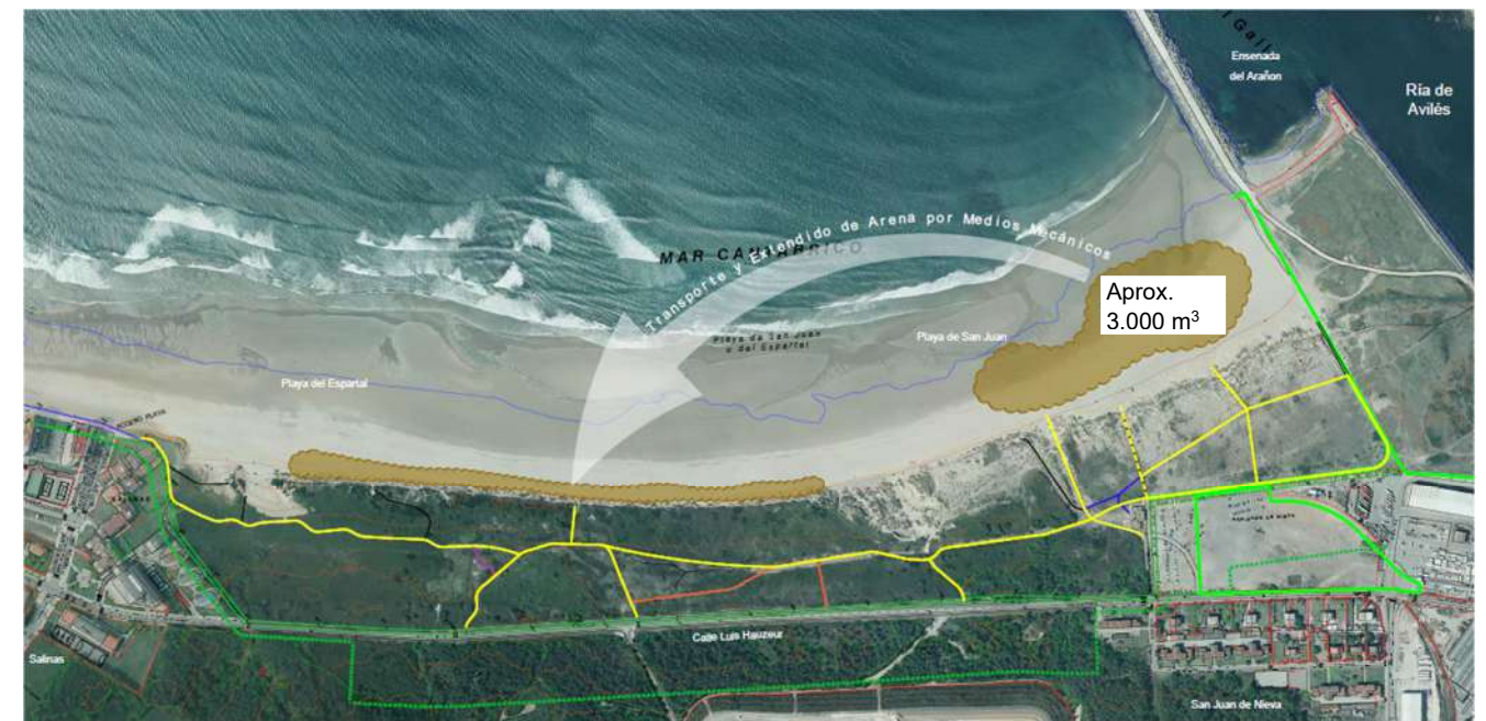
Figura 1 Zona de redistribución de arena
