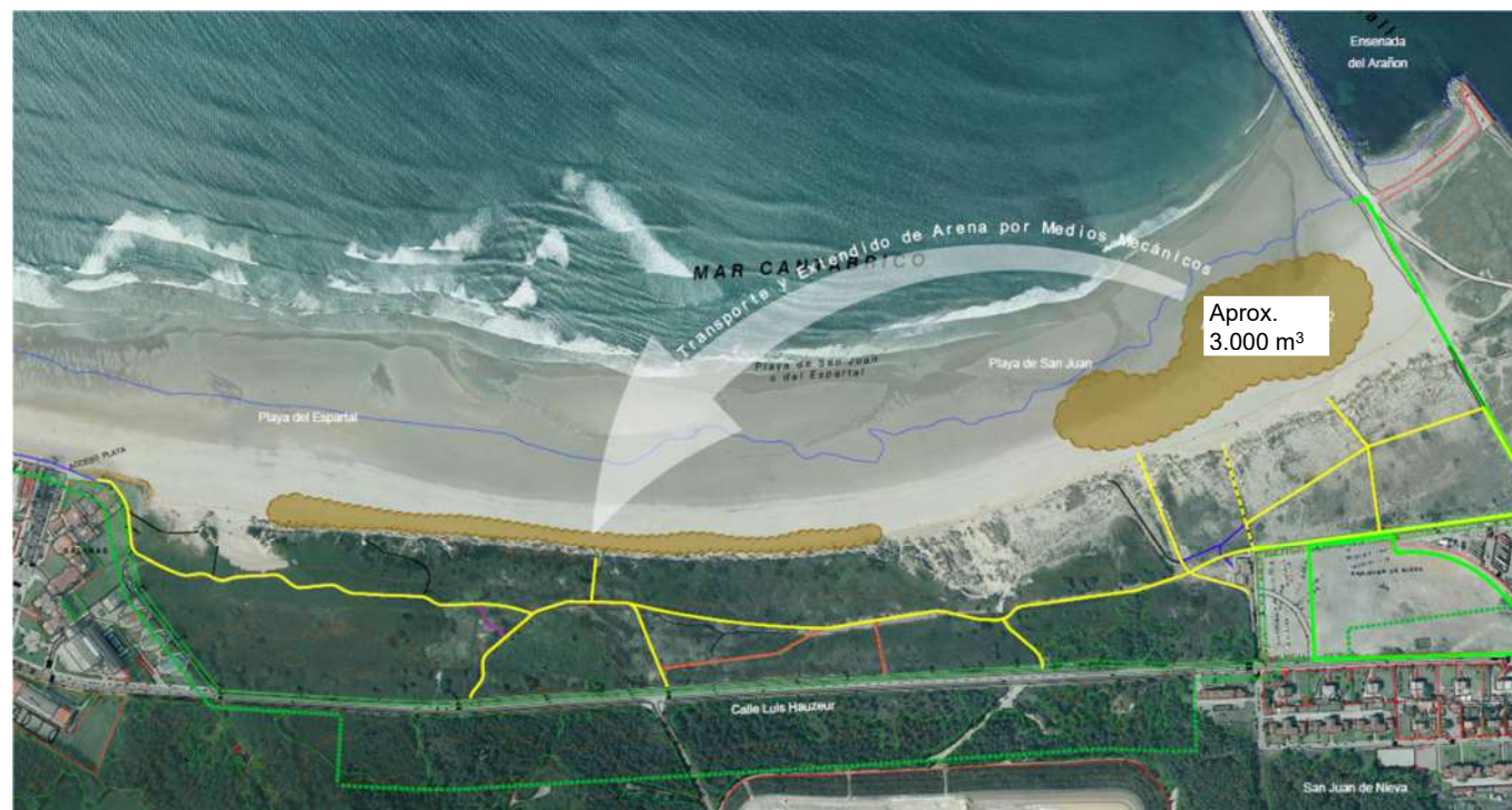
Figura 10 Zona de redistribución de arena
