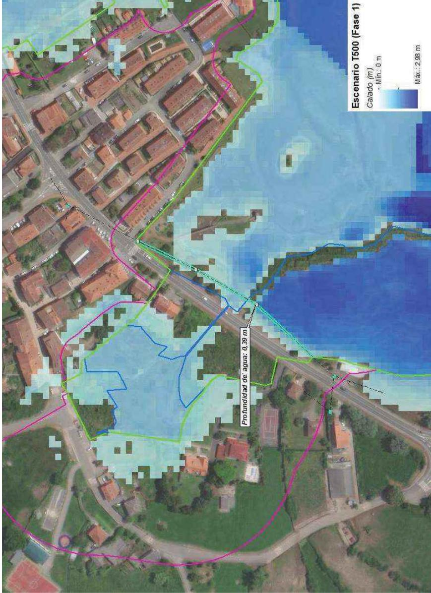
Imagen 7.3.7. Fase 1 de la simulación de la peligrosidad por inundación a 500 años de los apoyos incluidos dentro del dominio público marítimo-terrestre de la línea eléctrica aérea de baja tensión del CT La Ribera.
