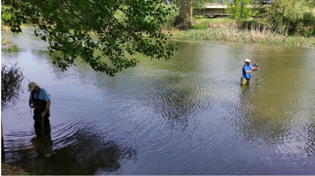
Fotografía 23. Aforo de caudales en una sección natural de río.
