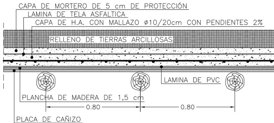
SECCION, DETALLE DE FORMACION DE CUBIERTA
