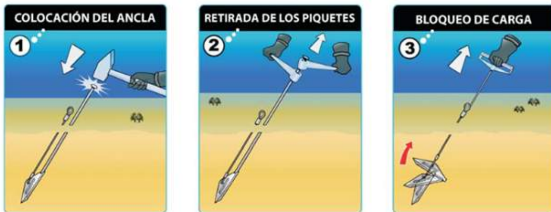
Figura 2: Esquema del sistema de instalación de las anclas Platipus .
