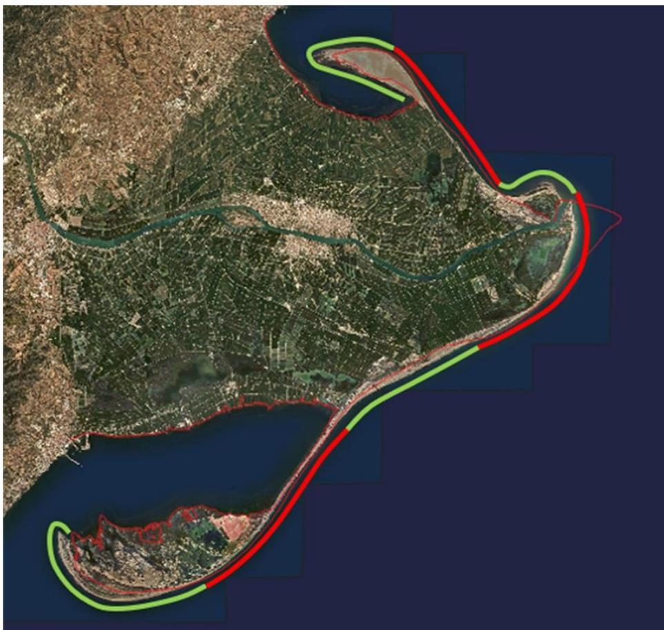
**Figura 2.** Evolución a largo plazo de la línea de costa del Delta del Ebro en las condiciones actuales. En rojo zonas de erosión y en verde zonas de deposición.
