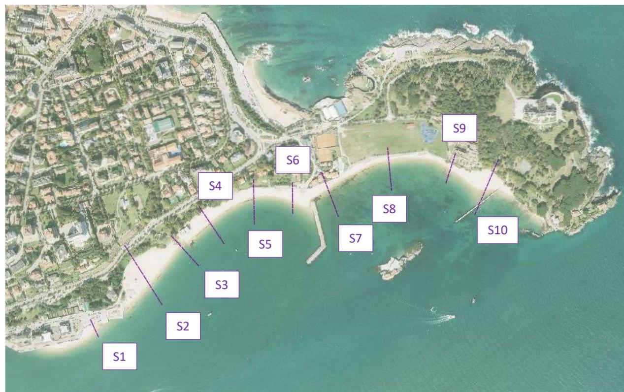
Imagen 13. Secciones de control para la obtención de magnitudes correspondientes a la evolución histórica de la línea de costa en la zona de estudio, correspondientes a las zonas 1 a 3. Análisis mediante imágenes obtenidas a partir de vuelos del IGN. Fuente: Elaboración propia.
