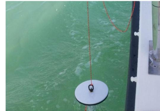
Figura 8. Medida de la profundidad de Secchi.
