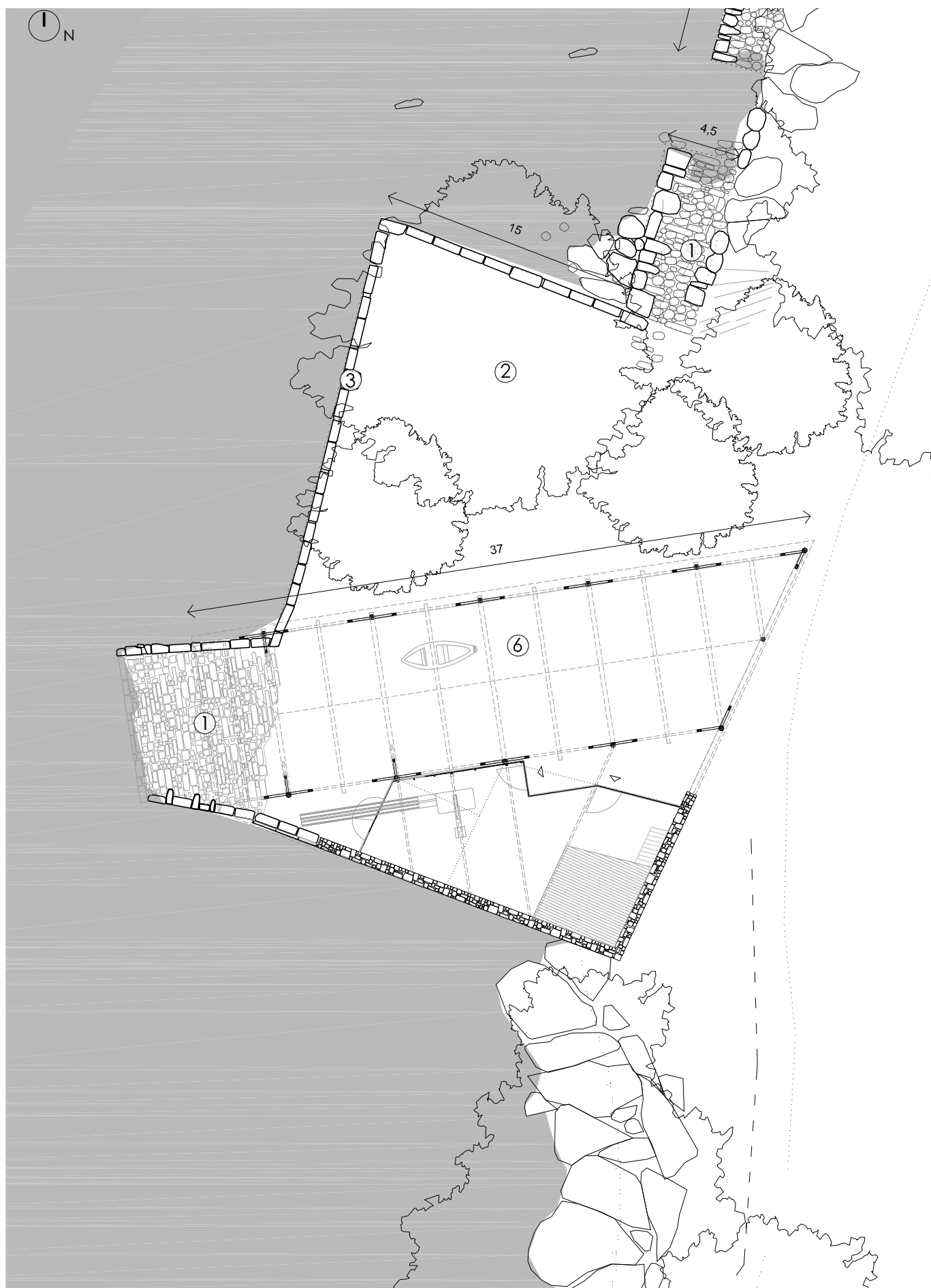
1-Rampla|2-Plataforma de traballo|3-Muro litoral|4-Peirao|5-Caseta|6-Carpintería de ribeira|7-Estaleiro tradicional|8-Amarres PLANTA | Escala 1/300 Todas as cotas do plano son aproximadas e redondeadas a \pm 0,5m
