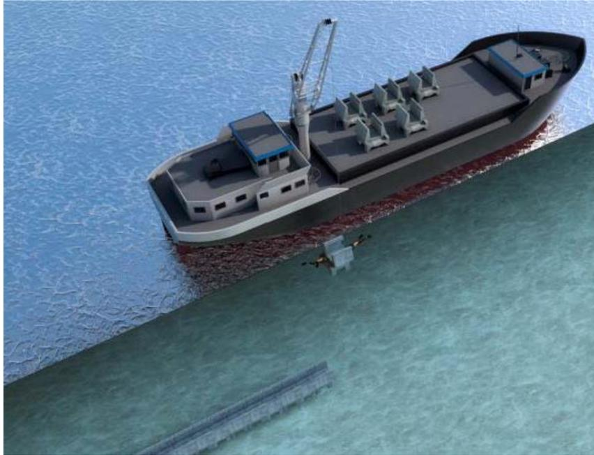
Figura 65. Esquema de posicionamiento de gánguil respecto al trazado del Emisario
