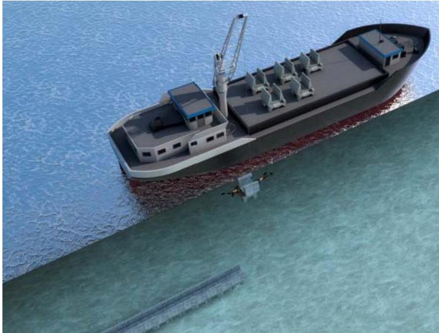
Figura 7. Esquema de posicionamiento de gánguil respecto al trazado del Emisario
