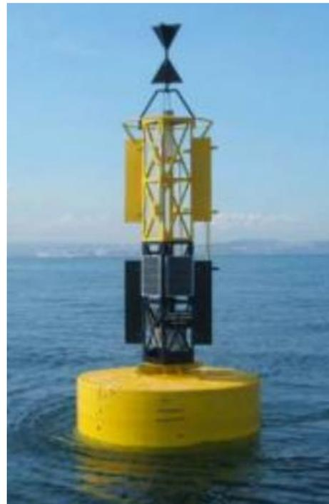
*Figura 18. Representación e imagen de boya de castillete de señalización cardinal oeste*
