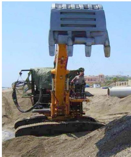
RETROEXCAVADORA SUBMARINA de 42Tn de peso para la realización de trabajos submarinos hasta 60m de profundidad.
