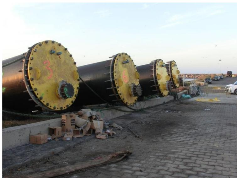
Figura 8. Bridas ciega de cierre para llenado y hundimiento de la conducción
