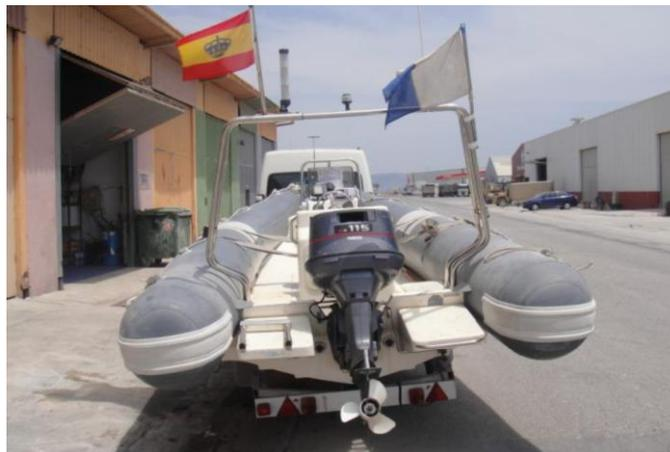
*Figura 11. Embarcación semirrígida fueraborda*
