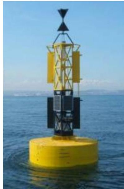
Figura 70. Representación e imagen de boya de castillete de señalización cardinal oeste
