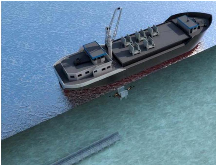
Figura 35. Esquema de posicionamiento de gánguil respecto al trazado del emisario
