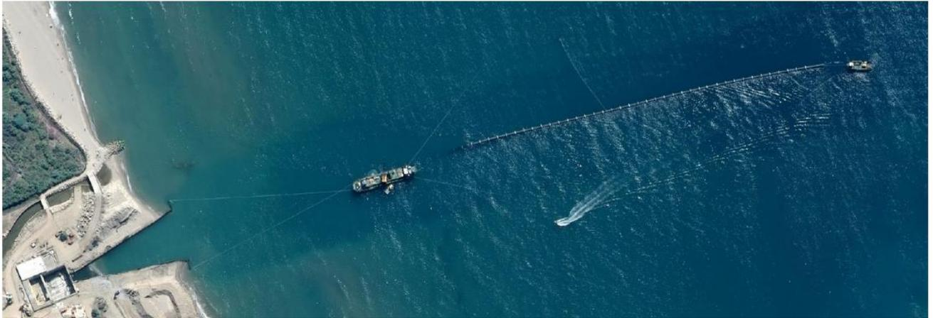
Figura 11. Imagen ejemplo de posicionamiento de embarcaciones en inicio de hundimiento de tramo
