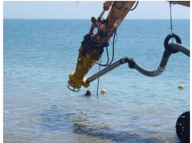
BOMBA HIDRÁULICA DE SUCCIÓN de arenas con removedor vertical en eje y enganche rápido, con las siguientes características técnicas:
