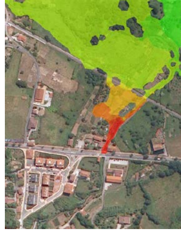
Figura 6.7.3.- Superficie inundada para un periodo de retorno de 10 años. Situación de proyecto con aliviaderos a cota 2,6 m. Detalle del casco urbano de Forua
