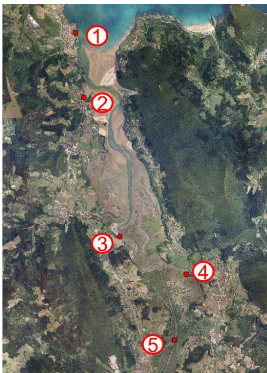
Figura 3.2.- Emplazamiento de las sondas de calado para medición de los valores de marea.
