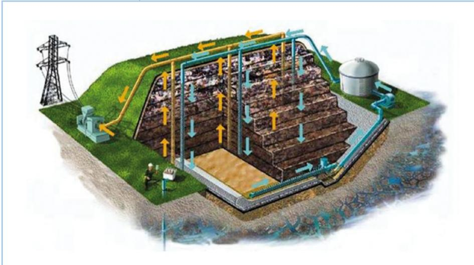
Figura 35. Esquema de un biorreactor activable.
