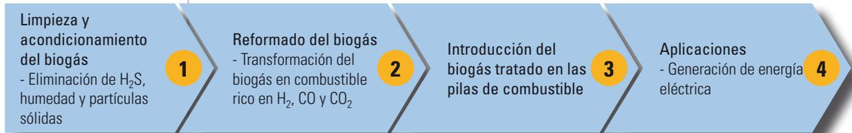
Figura 50. Esquema del proceso de pilas de combustible
