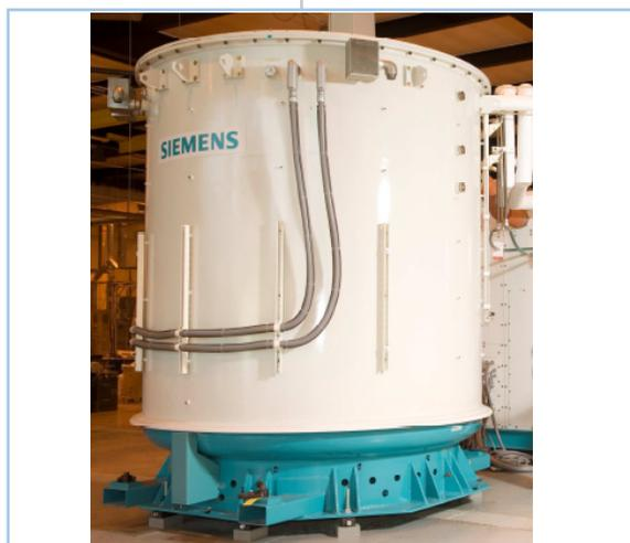
Foto 9: Pilas estacionarias MCFC.
