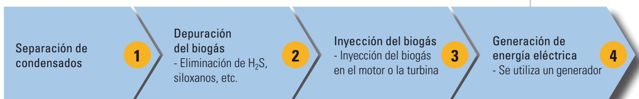
Figura 26. Esquema del proceso de generación de energía eléctrica
