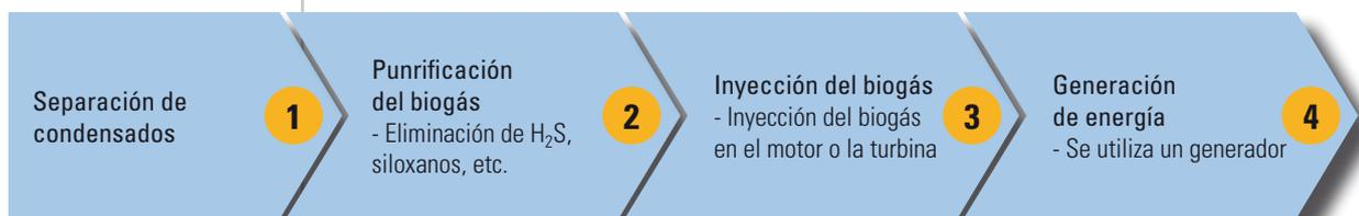
Figura 43. Esquema del proceso de generación de energía eléctrica
