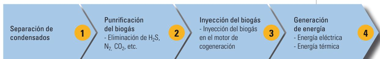
Figura 27. Esquema del proceso de cogeneración
