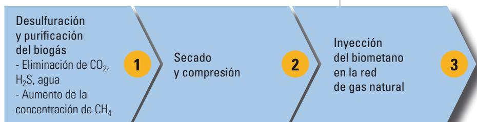
Figura 28. Esquema del proceso de inyección en gasoducto
