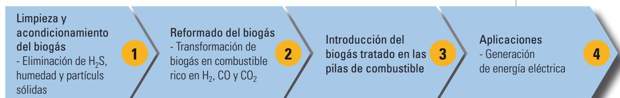
Figura 31. Esquema del proceso de pilas de combustible
