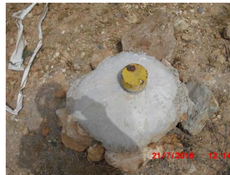
Detalle de inclinómetro para controlar los movimientos de la ladera.
