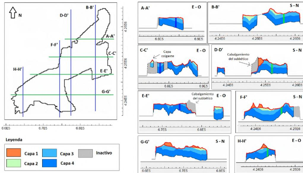
Figura 5. Modelo hidrogeológico de la masa de agua Quibas, compartida entre las demarcaciones hidrográficas del Júcar y del Segura. Perfiles de las capas del modelo Modflow.
