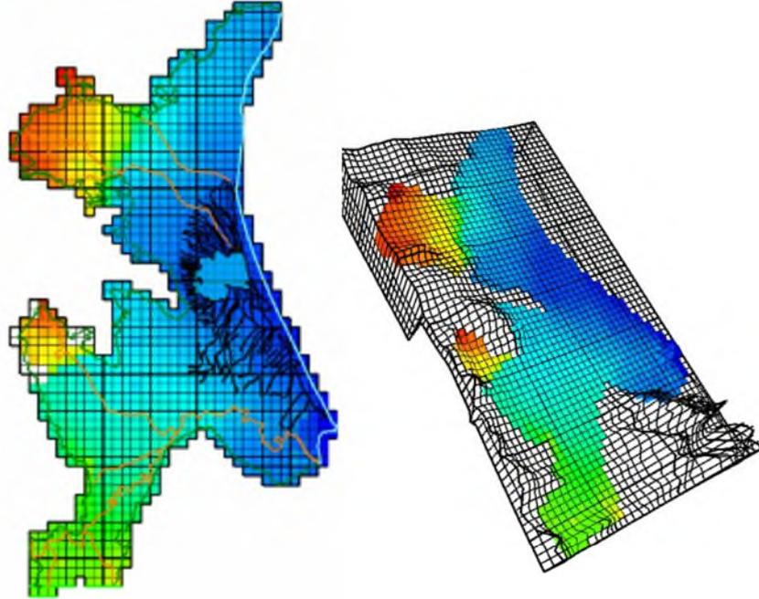
Figura 4. Modelo hidrogeológico de la Plana de Valencia con el software Modflow.
