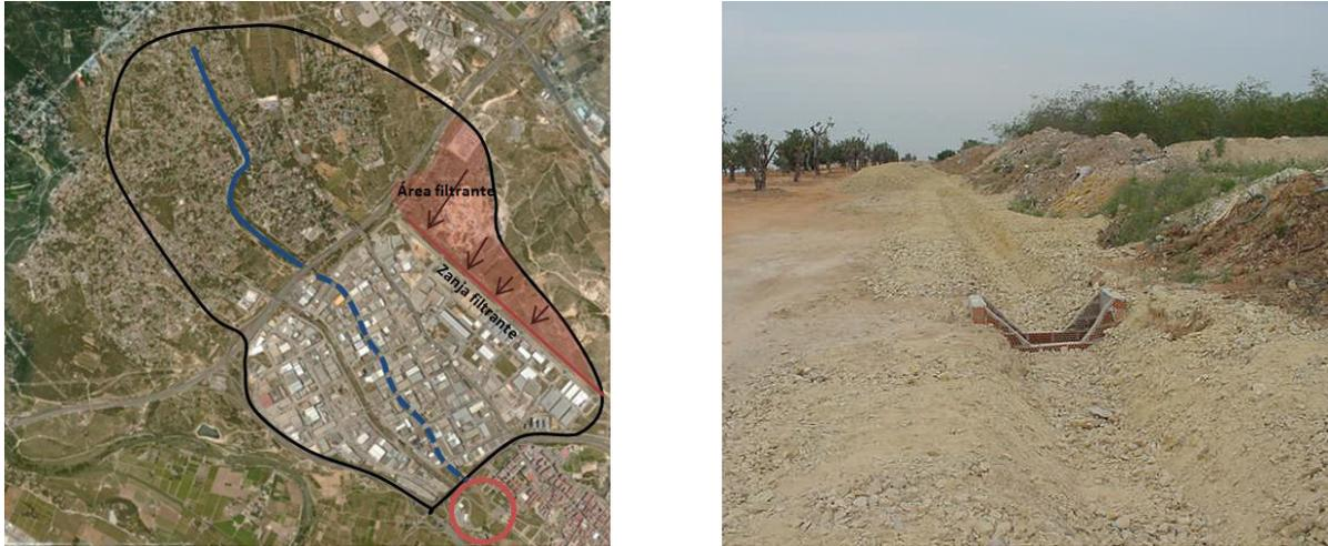
Figura 48. Área y zanja filtrante.
