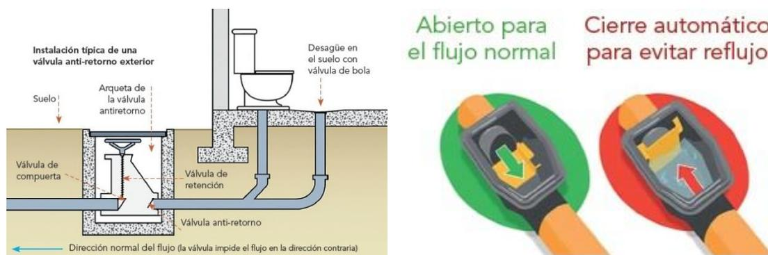
Fig. 49: Válvula antirretorno. Guía para la reducción de la vulnerabilidad de los edificios frente a las inundaciones. Dirección General del Agua y Consorcio de Compensación de Seguros. 2017.
