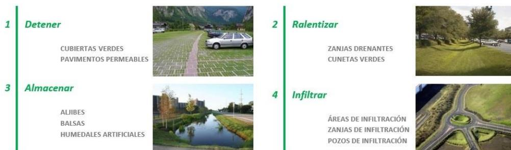
Fig. 55: Tipología de SUDS. Guías de adaptación al riesgo de inundación: sistemas urbanos de drenaje sostenible. 2019.
