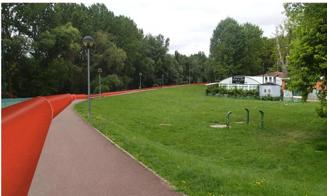
Fig. 41: Sistema TUBEWALL (Fuente: NOAQ) y propuesta de actuación (elaboración propia).
