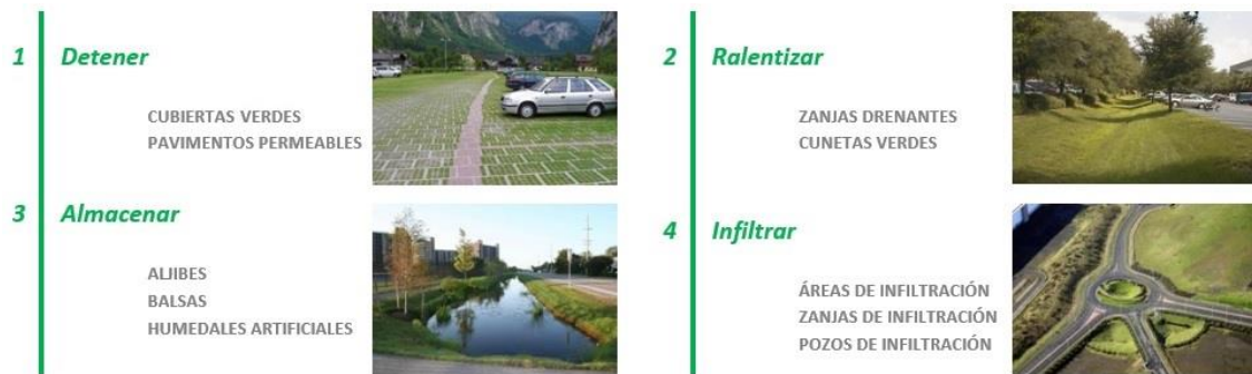
Fig. 44: Tipología de SUDS. Guías de adaptación al riesgo de inundación: sistemas urbanos de drenaje sostenible. 2019.
