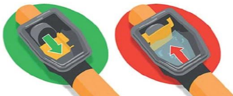
Fig. 41: Válvula antirretorno. Guía para la reducción de la vulnerabilidad de los edificios frente a las inundaciones. 2017.
