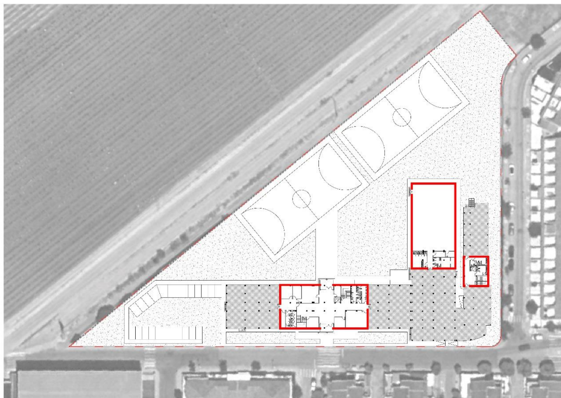
Fig. 37: Medidas de tipo RETIRAR. Esquema en planta: reducción de la ocupación en planta baja y ampliación del porche.
