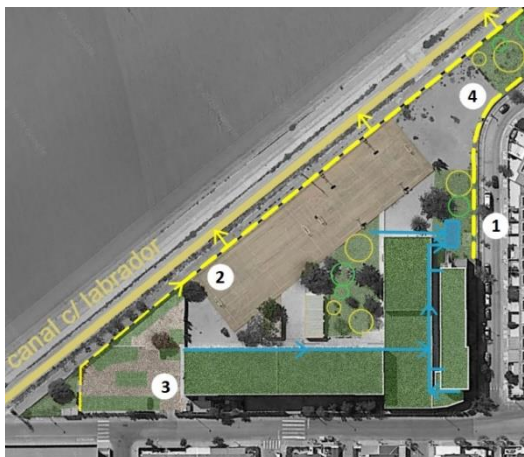
Fig. 45: SUDS. Esquema en planta. 1 cubierta verde y aljibe, 2 zanja drenante, 3 pavimento permeable, 4 franja de vegetación.
