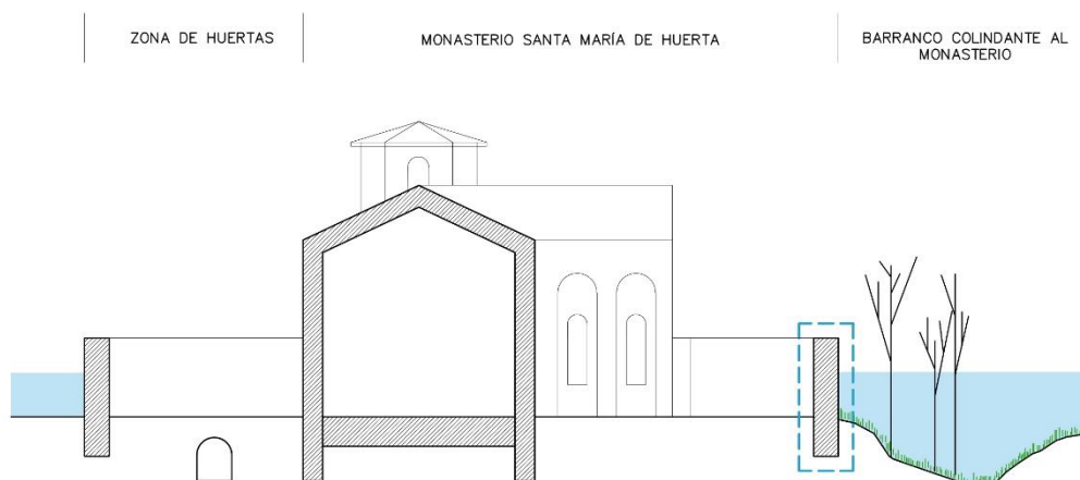
Fig. 36: Consolidación del muro exterior sudoeste.
