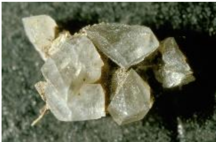
Figura 8. Cristales de estruvita obtenidos en una planta de procesamiento de estiércol líquido de Hannover (Alemania). Ancho de la imagen: 7,5 mm (Wikipedia).
