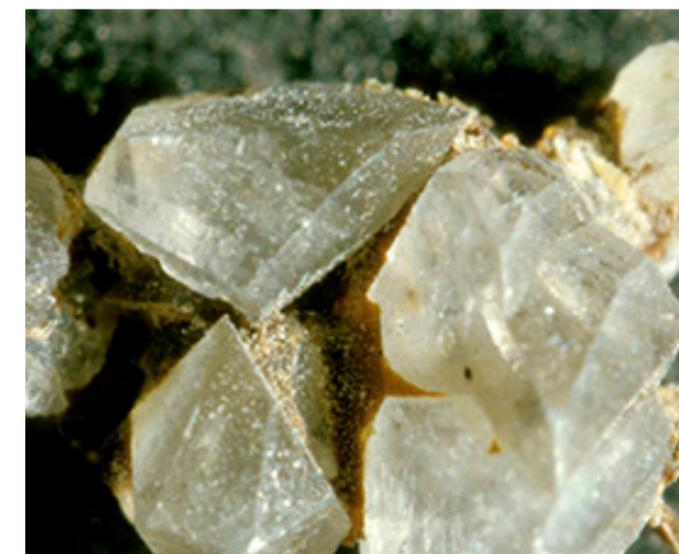
**Figura 14.** Cristales de estruvita obtenidos en una planta de procesamiento de estiércol líquido de Hannover (Alemania). Ancho de la imagen: 7,5 mm (Wikipedia).
