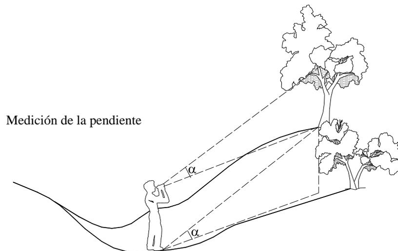
**Figura 20 – Posición para medir la pendiente**
