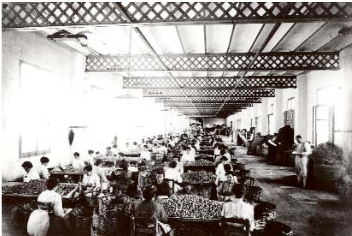
Figura 180 Selección manual de tapones de corcho en una factoría de Palafrugell en 1916. La industria del corcho nació y se desarrollará ligada a la fabricación de tapones. Sin embargo, desde principios del siglo XX se comenzará a utilizar el corcho de peor calidad o los sobrantes para la elaboración de otros productos.
