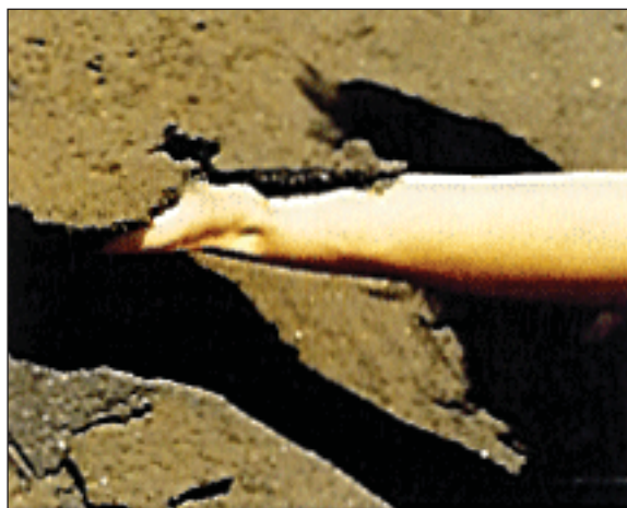
Figura 4.19: Formación de costra en la superficie de una pila de almacenamiento [134, Corus, 1995]
