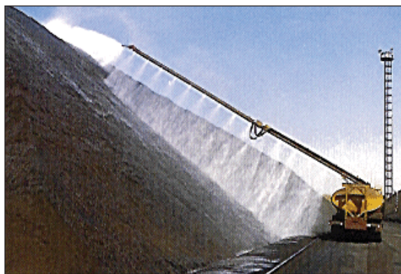
Figura 4.20: El rociado uniforme tiene una importancia capital para la formación de una costra adecuada [134, Corus, 1995]
