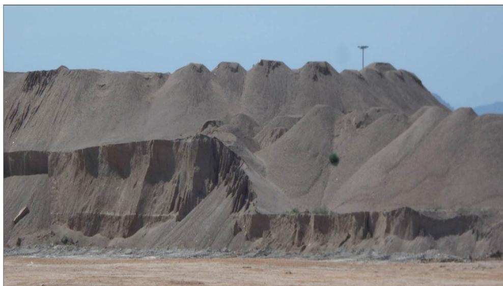
**Figura 17.** Material de rechazo del precibado de finos acopiado en planta de reciclaje
