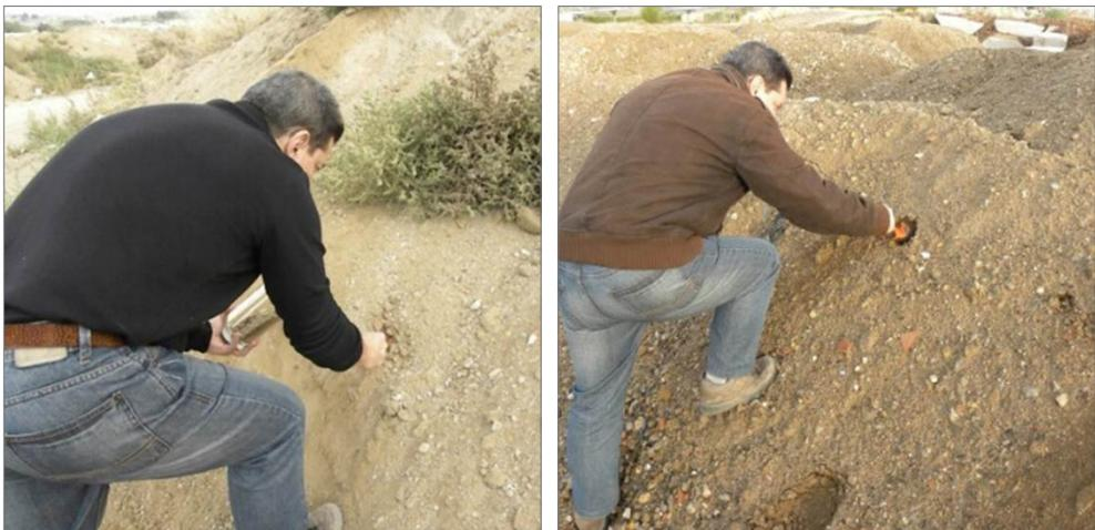
**Figura 6.** Toma de muestras de material de rechazo (precibado) de hormigón y mezcla hormigón-cerámicos para determinación de parámetros orgánicos (BTEX, PCB, aceites minerales y HPA)
