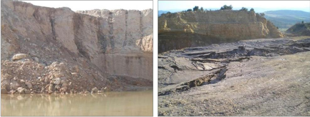
**Figura 12.** Grietas verticales y desprendimientos en una gravera (izquierda). Grietas de tracción en cabecera de un talud de una explotación de arcillas (derecha)
