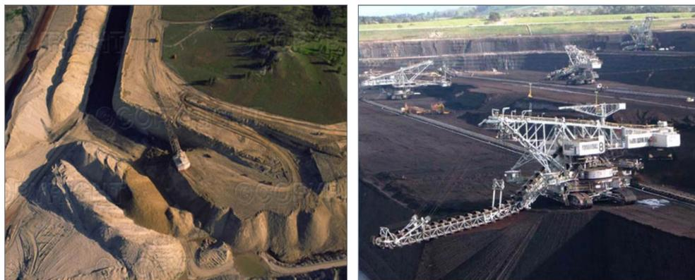
**Figura 3.** Izquierda: explotación de carbón por el método de descubierta (Romero, 2006). Derecha: explotación de carbón por el método de terrazas (Herrera Herbert, 2006)
