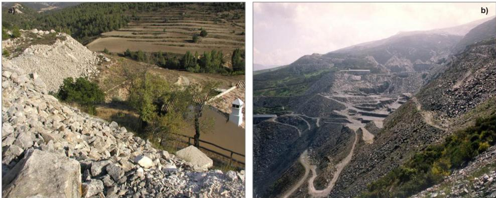
**Figura 8.** a) Escombrera de una explotación de mármol (Cehegín, Región de Murcia). b) Escombreras de una explotación de pizarra (Comarca de la Cabrera, León)
