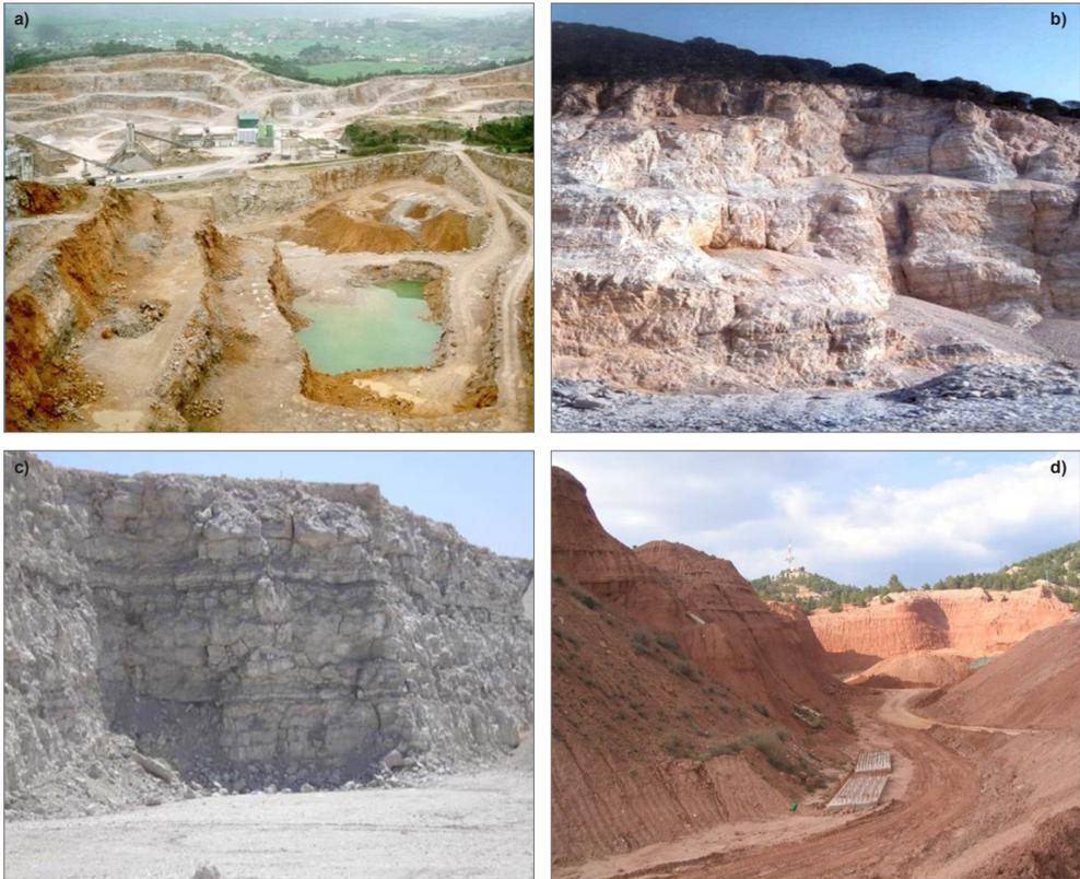
**Figura 5.** Canteras de rocas industriales de: a) y b) calizas para áridos de machaqueo en Camargo (Cantabria) y Alhaurín de la Torre (Málaga); c) yesos en Pina de Ebro (Zaragoza) (Rubio Navas *et al.*, 2007); y d) arcillas en Teruel
