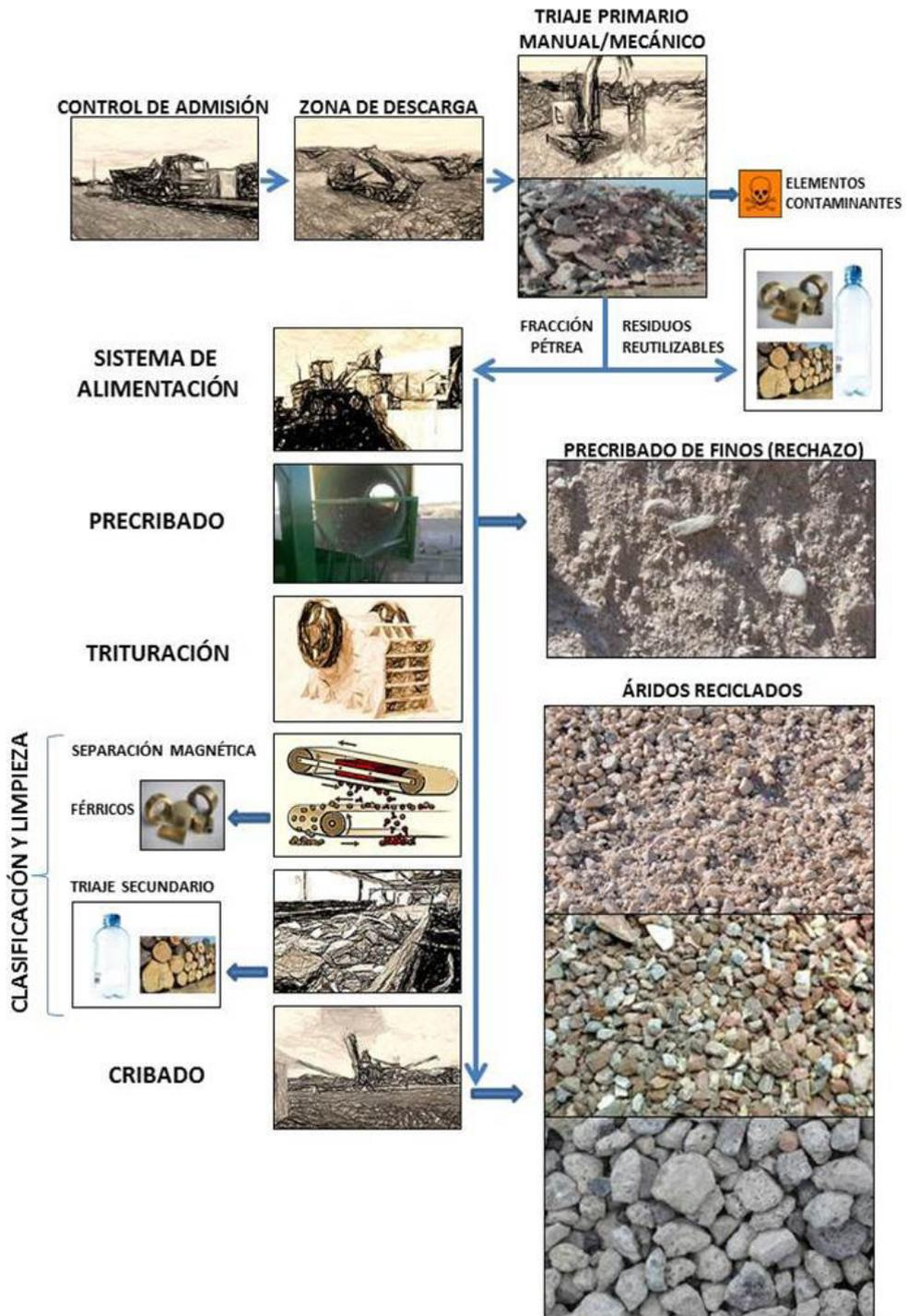
**Figura 16.** Esquema básico del proceso de reciclaje de RCD en plantas fijas de gestores autorizados
