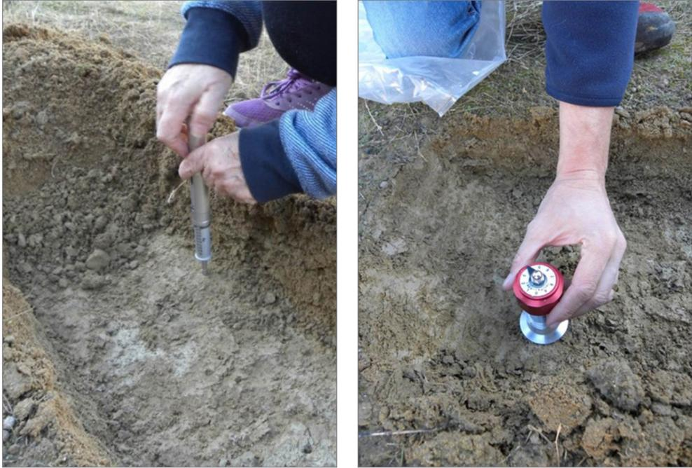
**Figura 22.** Ensayos de resistencia a la compresión simple con penetrómetro de bolsillo de hasta  $5 \text{ daN/cm}^2$  (izquierda) y de resistencia al corte con vane test (derecha) en condiciones no drenadas
