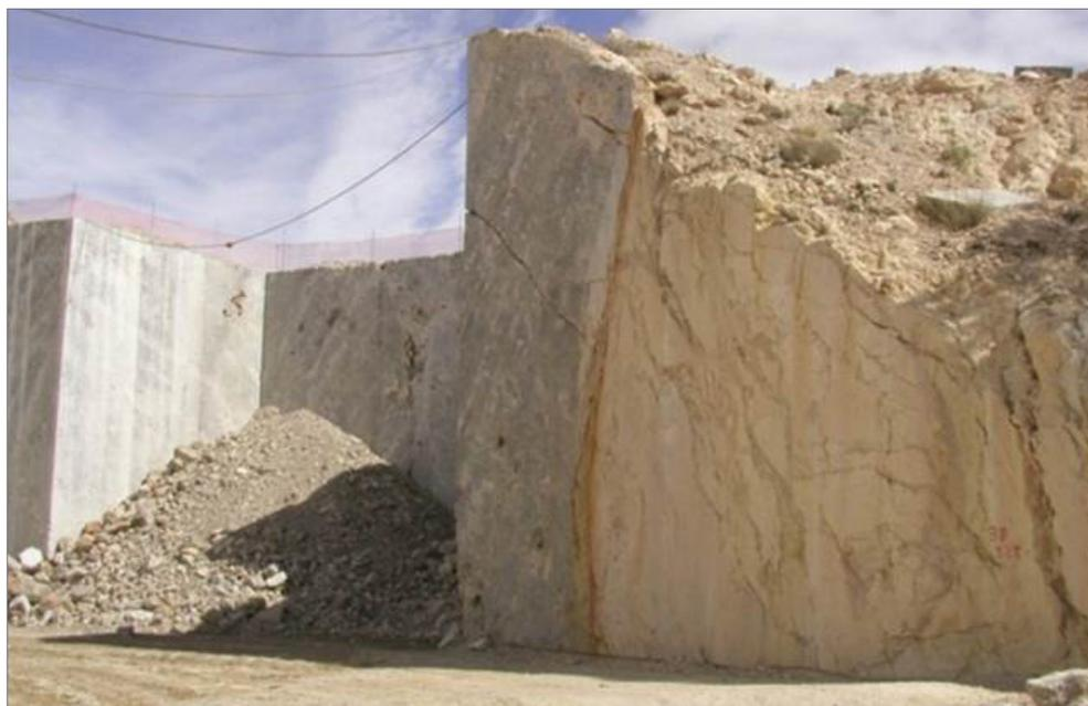
**Figura 22.** Discontinuidad geológica en un talud vertical en los límites de una cantera de mármol comercial (Sierra de las Andaluzas, Murcia). Se distingue un cambio neto de la roca competente (gris) a un material mucho más blando y deleznable (beige)
