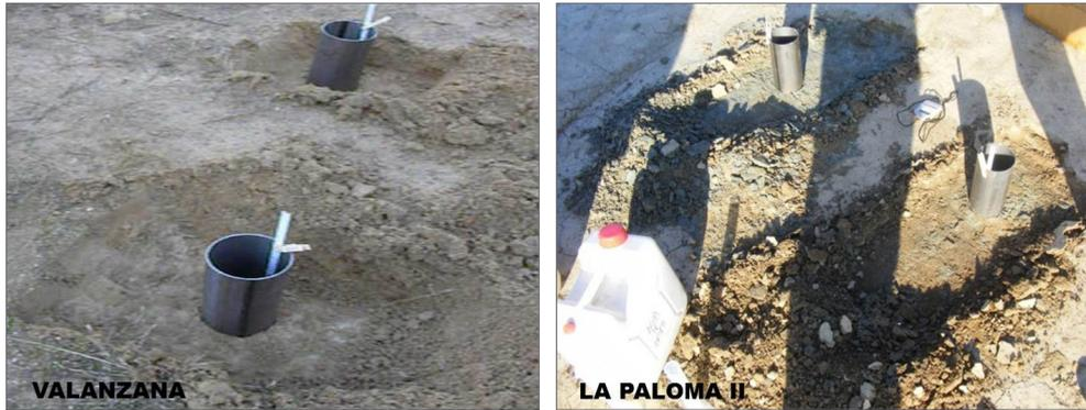
**Figura 14.** Ensayos para la determinación de la conductividad hidráulica *in situ* en el fondo de los huecos de las canteras Valanzana y La Paloma II por el método de Hatt & Le Coustumer (2008)
