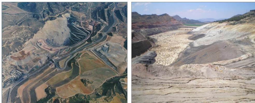
**Figura 2.** Minería de transferencia y relleno final del hueco residual con yesos de desulfuración en la Corta Barrabasa (Andorra, Teruel) (ENDESA GENERACIÓN, S.A.)
