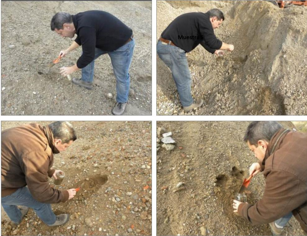
**Figura 5.** Toma de muestras de material de rechazo (precibado) mixto-cerámico para determinación de contenidos totales de parámetros orgánicos (BTEX, PCB, aceites minerales y HPA)
