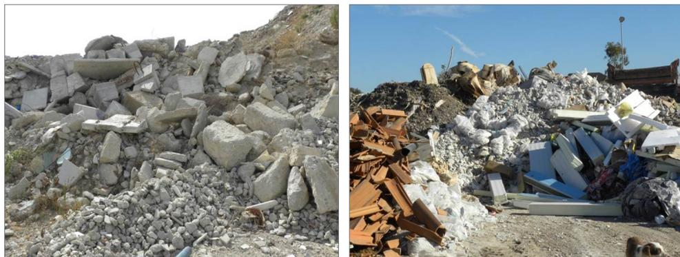
**Figura 15.** RCD de hormigón (Izq.) y mixto-cerámicos (Dcha.) acopiados en la zona de descarga antes de la separación de elementos reutilizables (plásticos, madera, etc.) y otros elementos contaminantes
