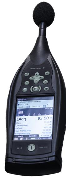
**Ilustración 19.** Sonómetro de bajo coste.
