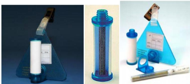
**Ilustración 12.** Ejemplos de sensores pasivos.
