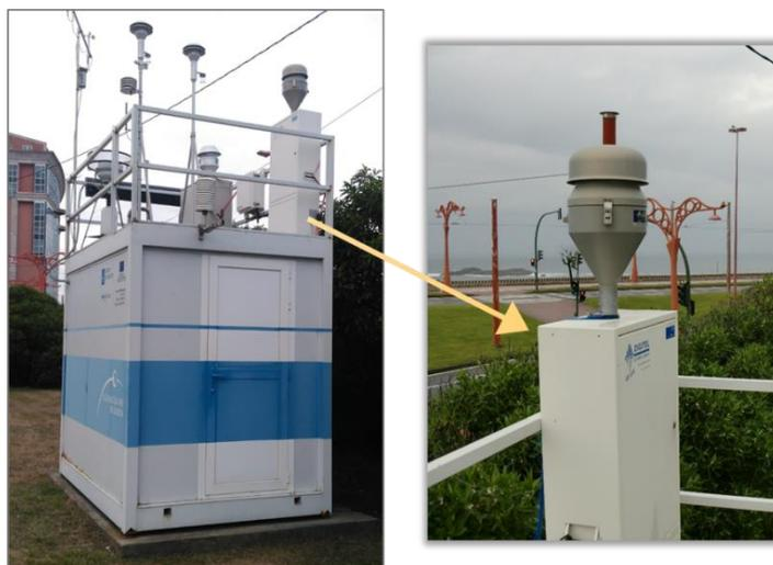
Imagen 3. Captador Digitel DHA-80 instalado en Torre de Hércules para muestreo de PM<sub>10</sub>.
