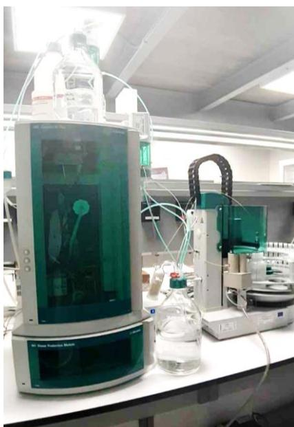
Imagen 5. Cromatógrafo iónico 930 Compact IC Flex del LMAG.
