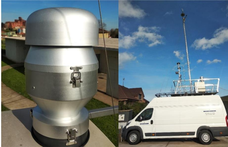
*Figura 14. Captador de alto volumen secuencial MCV CAV-A/MSb instalado en el techo de la Unidad Móvil de Control de Calidad del Aire de la Consejería de Medio Ambiente.*
