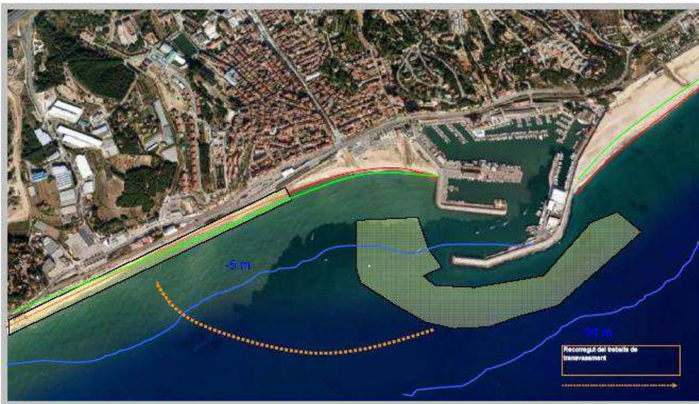
Figura 1.9: Trasvase de arena del puerto de Arenys de Mar a la playa de la Musclera por problemas de erosión (Fuente: Proyecto Constructivo. Dragado de los Puertos de Cataluña. Fase 4A: Trasvase. SENER 2010)
