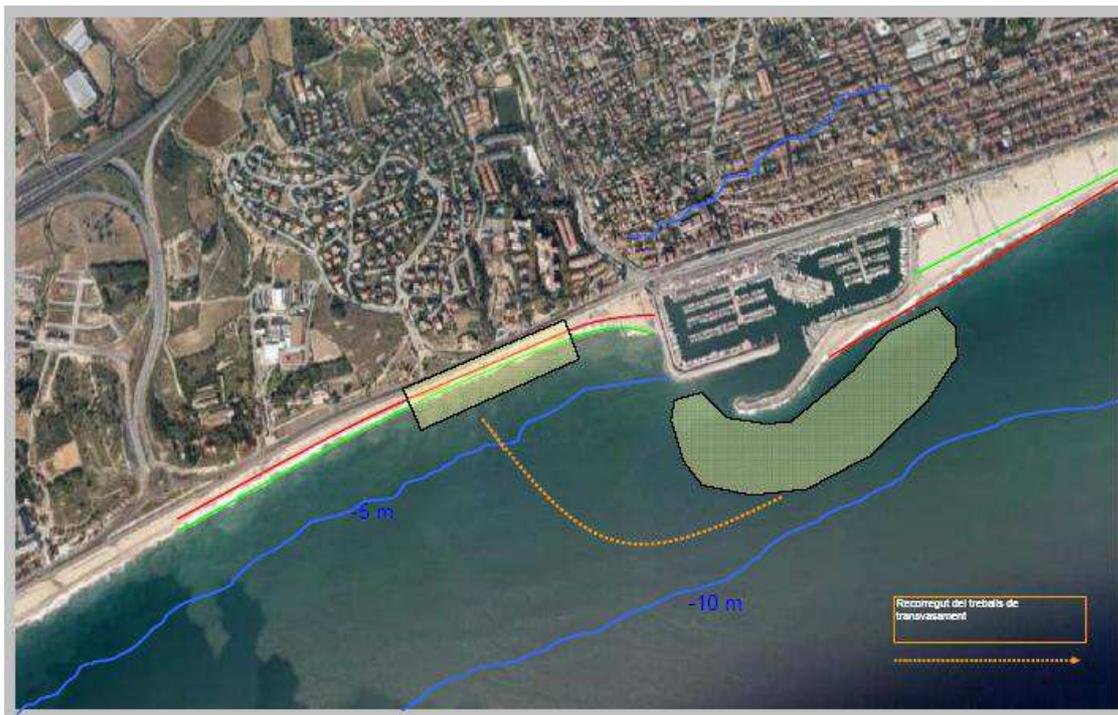
Figura 1.5: Traspase de arena del puerto de Masnou a la playa de Masnou (Fuente: Proyecto Constructivo. Dragado de los Puertos de Cataluña. Fase 4A: Traspase. SENNER 2010)
