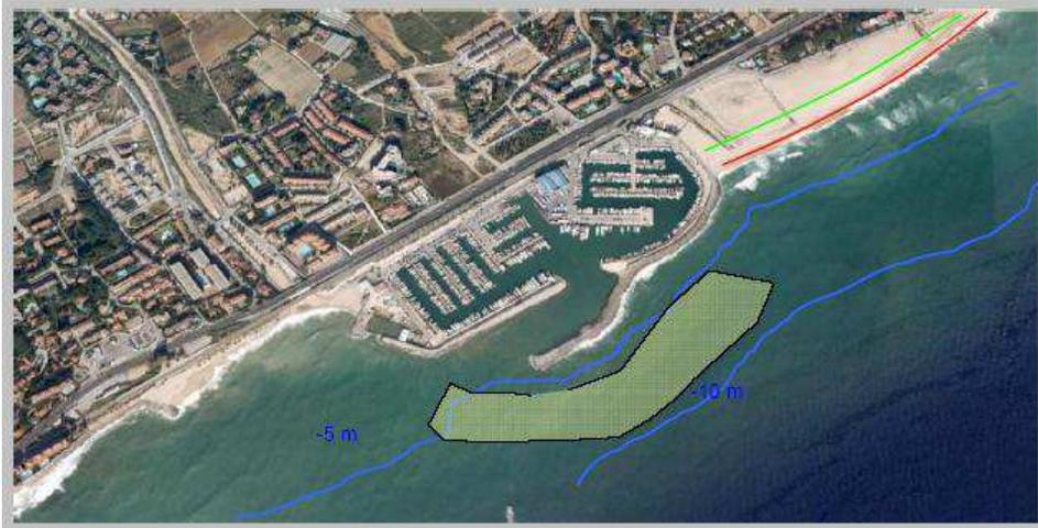
Figura 1.8: Trasvase de arena del puerto de El Balís a la playa de las Barcas o de la Cabrera en función de su necesidad de actuación (Fuente: Dragatge dels Ports de Catalunya. SENER 2010)
