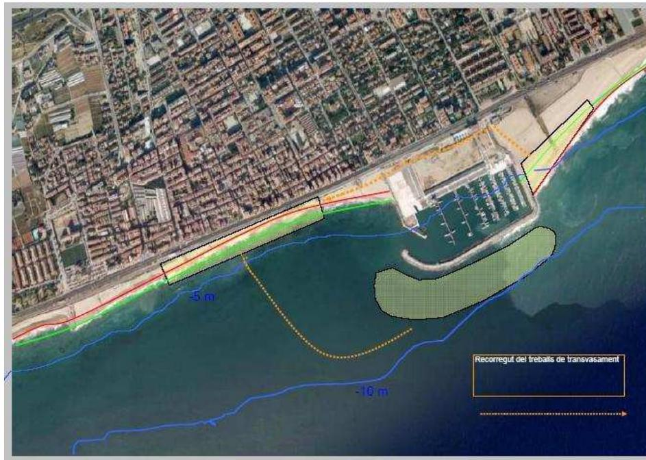
Figura 1.6: Traspase de arena del puerto de Premiá de Mar a las playas al sur (Fuente: Proyecto Constructivo. Dragado de los Puertos de Cataluña. Fase 4A: Traspase. SENER 2010)
