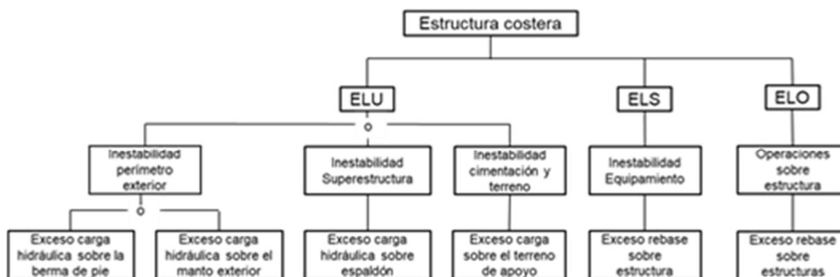
Figura 23 Ejemplo del árbol de fallo de una estructura costera. Las relaciones entre elementos / modos de fallo "o" obedecen a una conceptualización de sistema en serie en el que el fallo se alcanza si se produce alguno de los fallos individuales.
