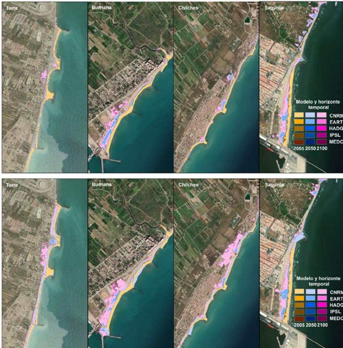
Figura 25. Comparación del alcance de la zona inundada asociada a la CI de 100 años de periodo de retorno para el escenario RCP8.5 en los años 2005, 2050 y 2100 y P95% de ANMM. En el panel superior se muestra la envolvente de modelos y en el inferior se representan los modelos desagregados.
