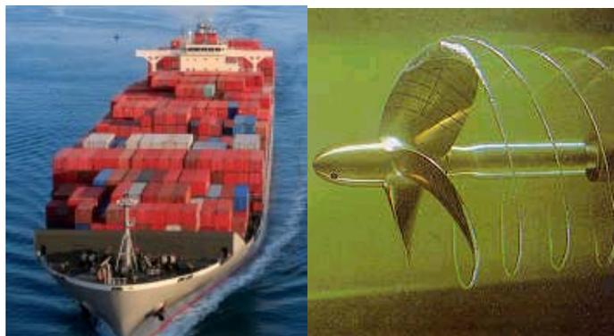
**Figura III.4.3.** *Izquierda:* Buque carguero. Existen más de 90.000 barcos de más de 100 toneladas de registro bruto en los océanos y el tráfico comercial de carga continúa incrementando. *Derecha:* Visualización de las burbujas de cavitación que genera una hélice al girar en un túnel de experimentación, produciendo ruido que llega a frecuencias altas. Figuras de IFAW (2008) y de Renilson-IFAW (2009).
