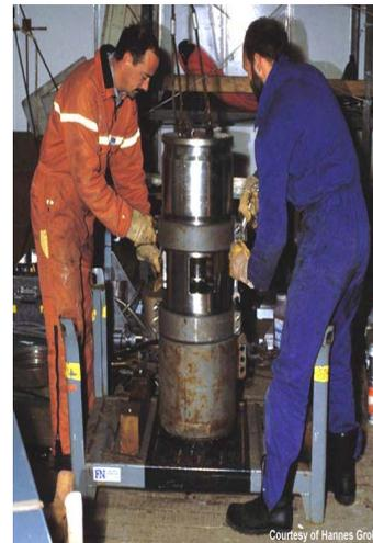
**Figura III.2.2:** *Izquierda:* Dibujo esquematizado del funcionamiento de una prospección sísmica, con un sistema de cañones de aire comprimido que emite señales acústicas y un sistema de hidrófonos, de varios kilómetros de longitud, que las recogen y transmiten al barco. *Derecha:* ejemplo de pistola o cañón de aire comprimido de gran calibre.
