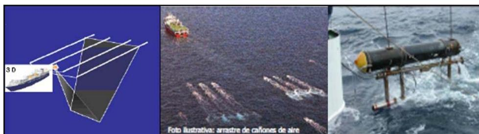
**Figura III.2.1.** Izquierda: esquema de prospección sísmica 3D; centro: barco sísmico arrastrando un sistema de cañones de aire comprimido compuesto por varios grupos de cañones para obtener datos 3D; derecha: cañón (o pistola) de aire comprimido ("airgun"). Imágenes tomadas de PETROENAP, Abrus Cia EIA. Los cables de arrastre de hidrófonos de este proyecto tenían una longitud de 9 km.
