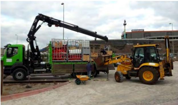
**Figura 2.** Descargando material del camión pluma por la retrocargadora mixta.
