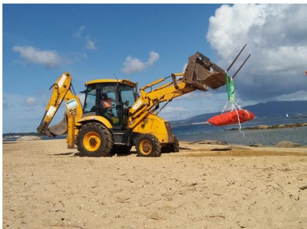
*Ilustración 6. Retrocargadora mixta.*
