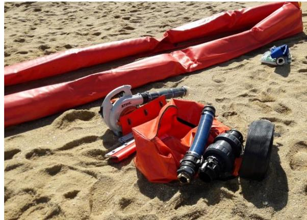
Ilustración 5. Sopladores y accesorios para el llenado de la barrera selladora.
