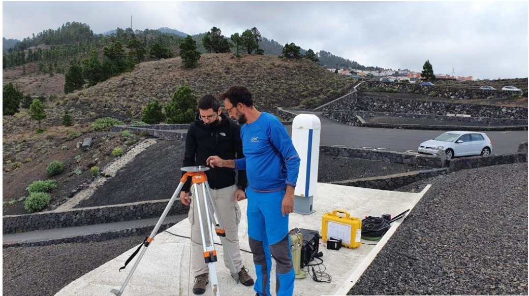
Fotómetro y celómetro desplegado en La Palma por parte del equipo del Centro de Investigación Atmosférica de Izaña de AEMET
