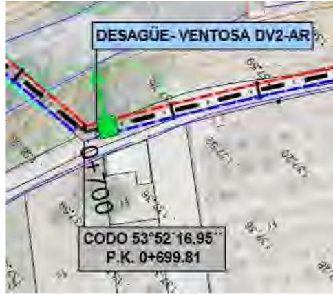
Esto queda también patente en el Plano, que adjunta el alegante, tomado del Anejo N°19.- Afecciones, Reposiciones y Servidumbres. Se adjunta seguidamente un recorte, algo mayor de dicho Plano del Anejo N°19 (Plano N° A-19-2.1 Hoja 3 de 18) de afección a la red de riego existente (línea azul) donde se observa que la edificación está junto a la linde del camino y acequia de riego existente.
