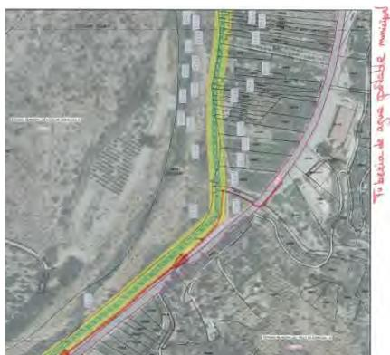
*Trazado de la tubería de agua potable en paralelo a la traza de la TC-200, entre P.K. 4+850 (desagüe del barranco del Cristo) a P.K. 5+220.*
