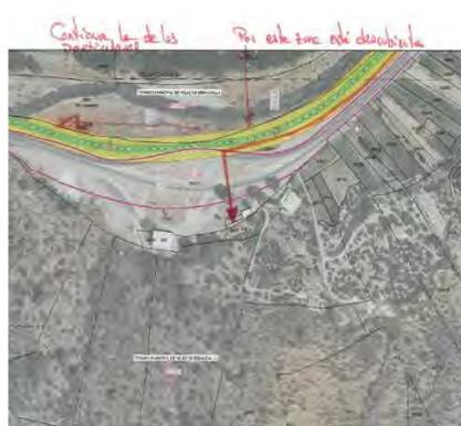
*Trazado de la tubería de agua potable en paralelo a la traza de la TC-200, entre P.K. 5+220 y P.K. 5+400.*
