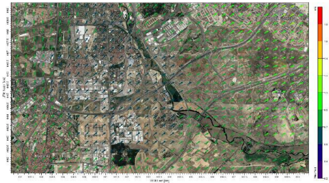
Figura 6.2.1.12. Campo de vientos a 10 m de altura a las 12:00 h del 19/03/2017 para la EDAR Butarque.
