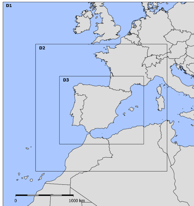
Figura 5.2.1.1. Dominios utilizados para el modelo meteorológico WRF.
