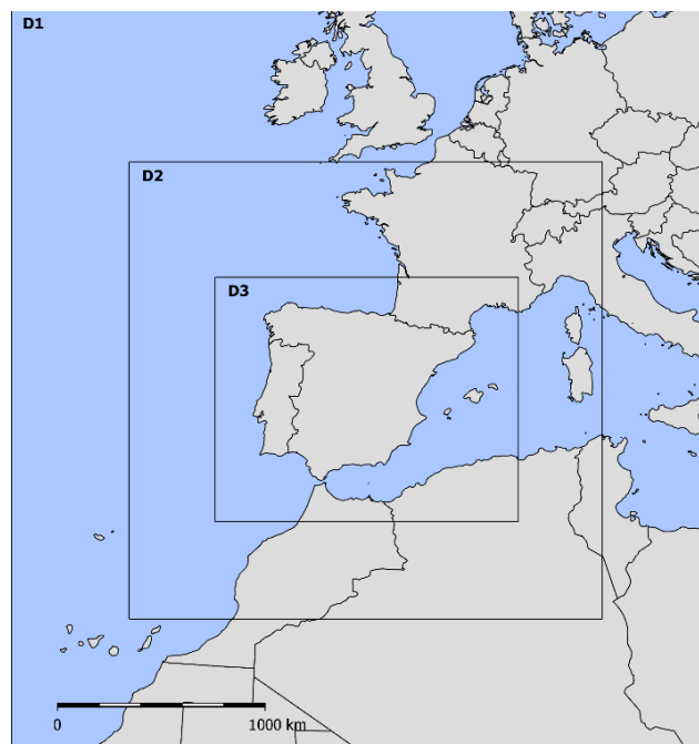
Figura 6.2.1.1. Dominios utilizados para el modelo meteorológico WRF.
