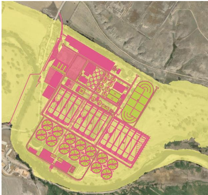
Ilustración 4. EDAR Sur nueva. Zona de inundación con probabilidad baja o excepcional (T=500 años)
