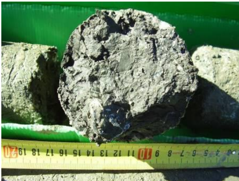
Detalle de mineralización de cristales de yeso en las arcillas grises de la formación yesífera.
