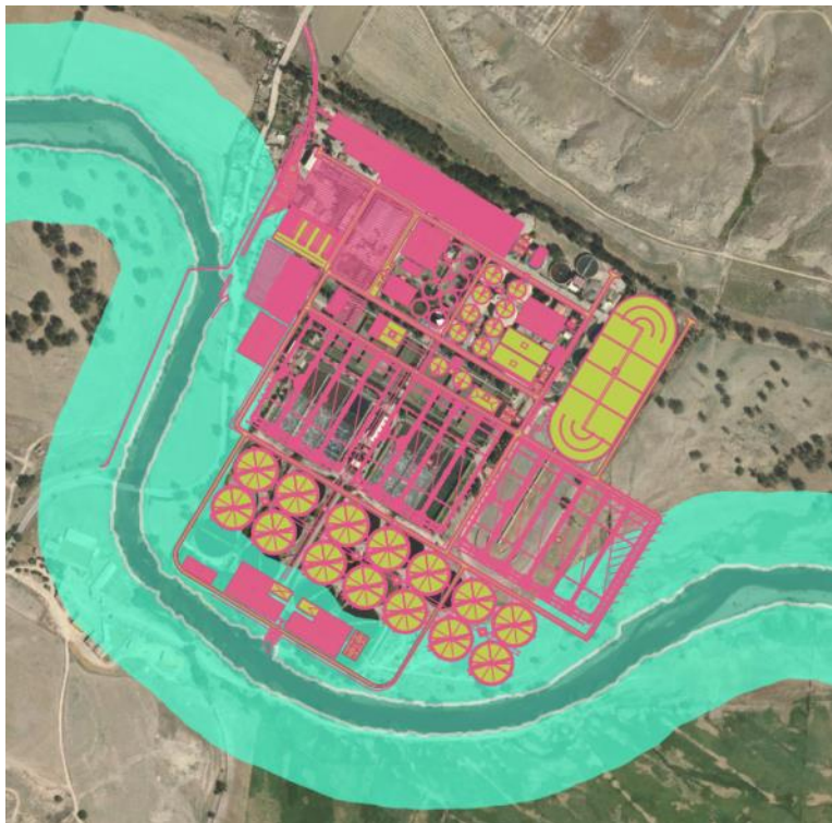
Ilustración 6 EDAR Sur nueva. Dominio Público Hidráulico Cartográfico
