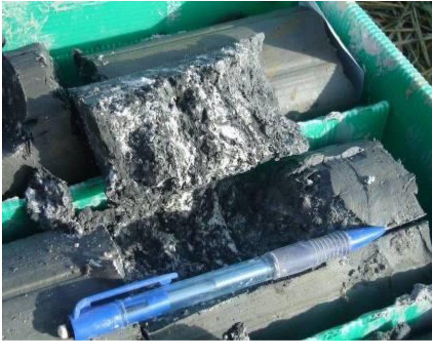
Arcillas con yeso en un sondeo junto a la ERAR Butarque. Se puede observar la microlaminación entre arcillas y yeso pulverulento.
