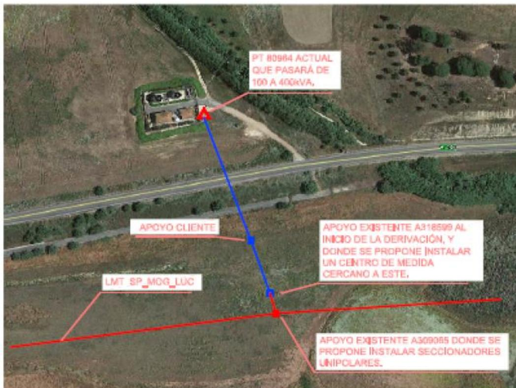
Ilustración 4. Línea Eléctrica proyectada para la EDAR de Lucena del Puerto.
