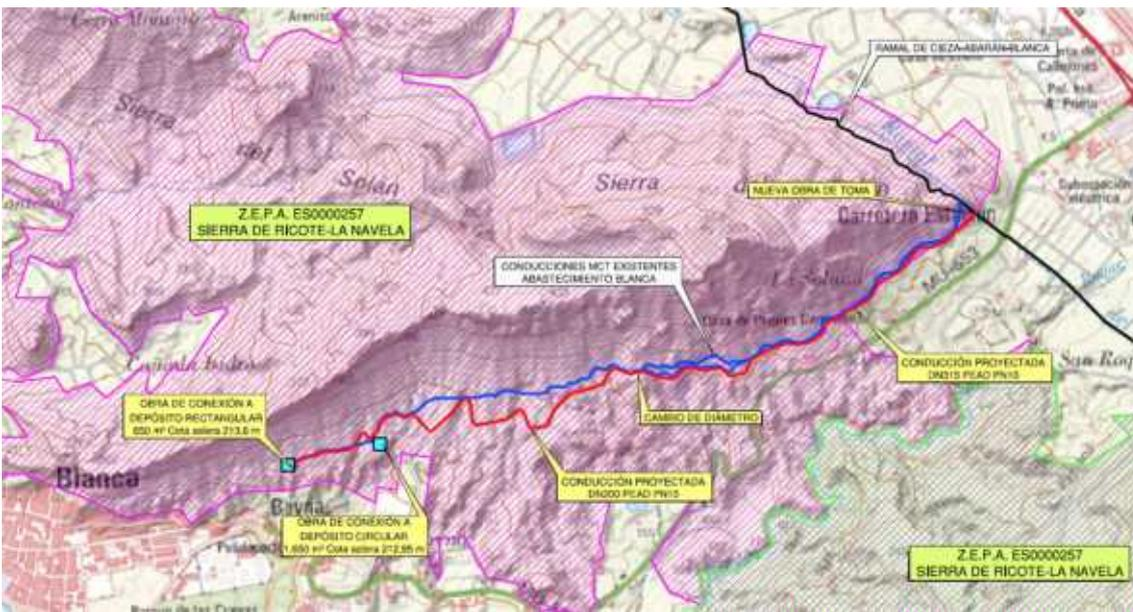
En el gráfico siguiente se muestra un esquema hidráulico de las instalaciones actuales, en azul, junto a las nuevas instalaciones proyectadas en rojo, indicándose las cotas más importantes de la instalación. Además se ha indicado las líneas piezométricas resultantes de 2 escenarios de funcionamiento.
