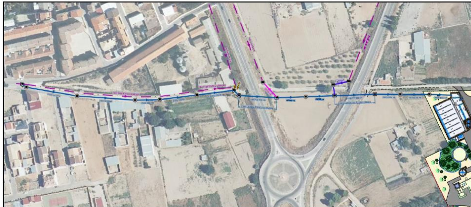
Trazado en planta del nuevo colector emisario
