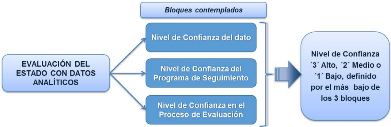
Figura 73: Esquema de la metodología propuesta para la determinación del nivel de confianza en la evaluación del estado.
