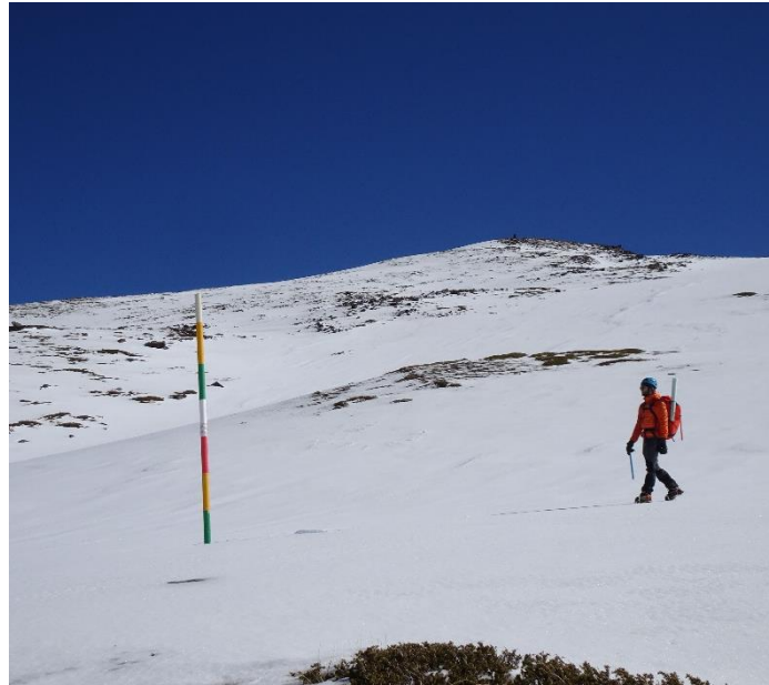
Figura 1. Técnico aproximándose a una pértiga perteneciente a la red ERHIN para realizar la medición visual de la misma
