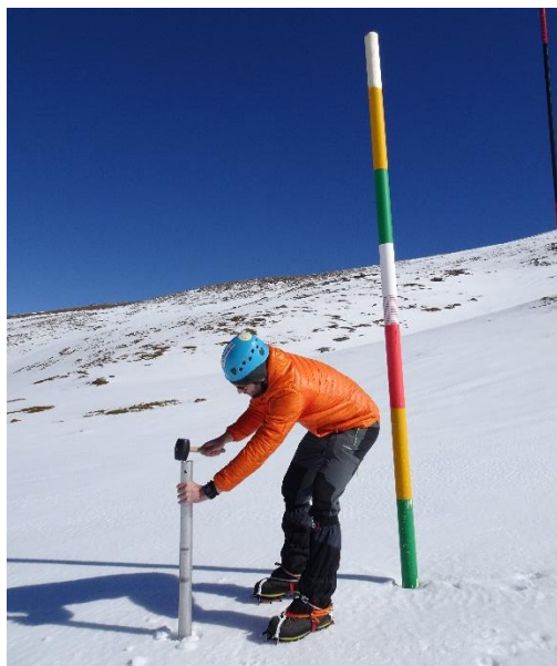
Figura 2. Técnico llevando a cabo pesaje de tubo sacamuestras para la obtención de la densidad de nieve
