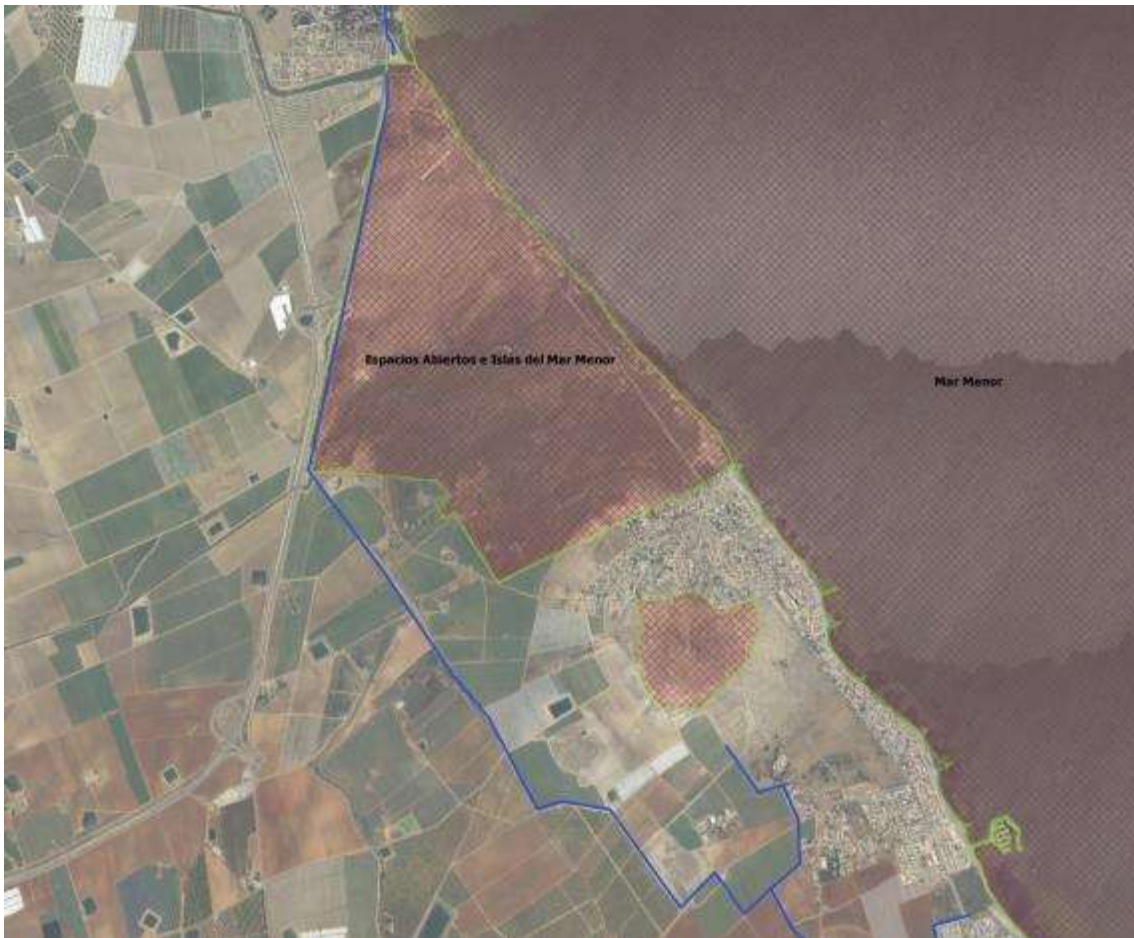
Figura: Trazado de la conexión de pequeñas aglomeraciones urbanas al sistema de saneamiento al Sur de la Rambla del Alujón en el humedal Marina del Carmolí, declarado LIC “Espacios Abiertos e Islas del Mar Menor” y ZEPA “Mar Menor”.
