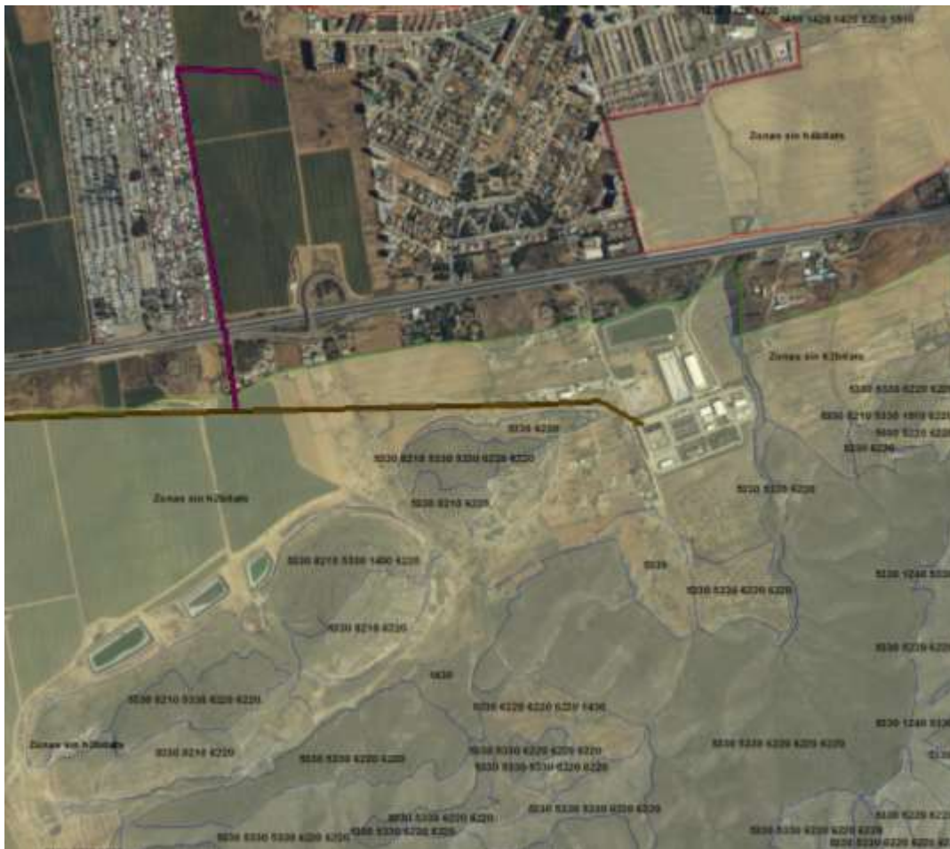
Figura: Detalle del trazado de las conducciones nuevas que se proyecta ejecutar y HIC en el LIC “Calblanque, Monte de las Cenizas y Peña del Águila”, coincidentes con el trazado de las conducciones en las inmediaciones de la EDAR de Mar Menor Sur.
