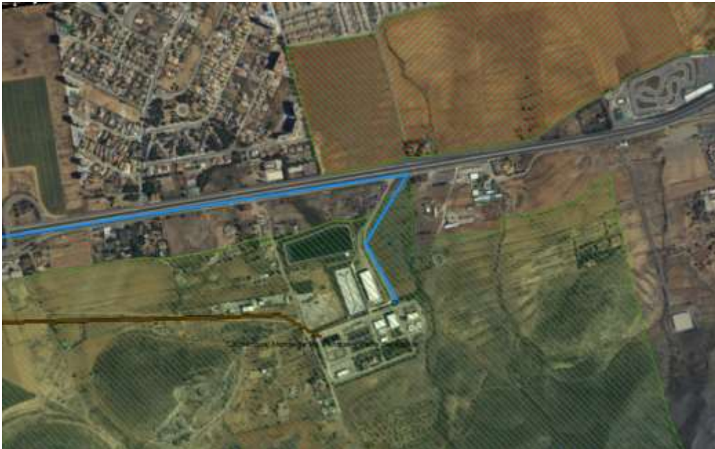
Figura: Trazado del colector cintura coincidente con el LIC “Calblanque, Monte de las Cenizas y Peña del Águila”, en el entorno de la EDAR Mar Menor Sur.
