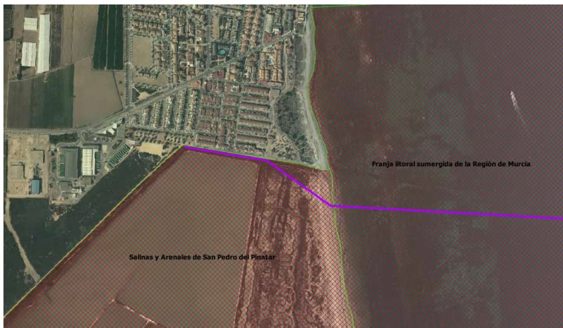
Figura: Trazado del emisario a través del LIC y ZEPA “Salinas y Arenales de San Pedro del Pinatar”
