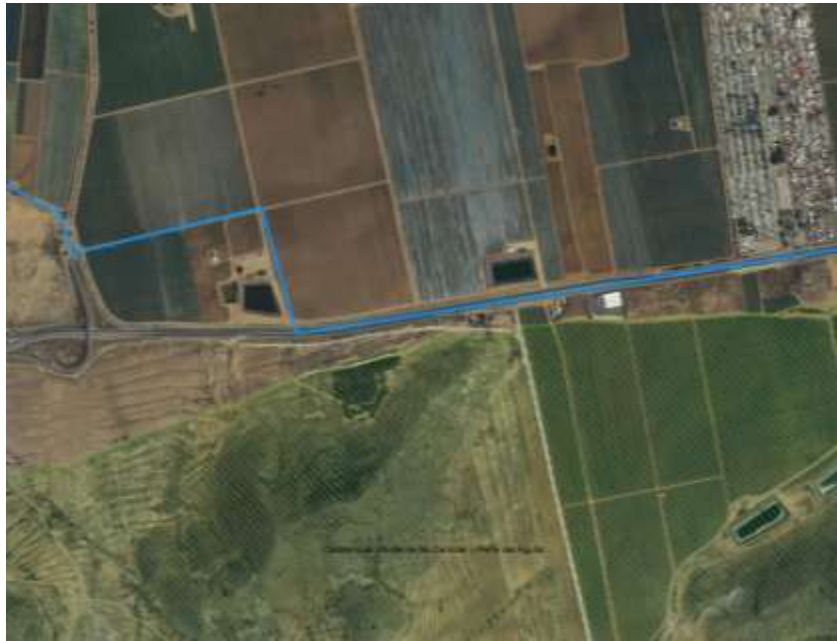
Figura: Trazado del colector para derivación de vertidos urbanos en el entorno próximo del LIC “Calblanque, Monte de las Cenizas y Peña del Águila”.
