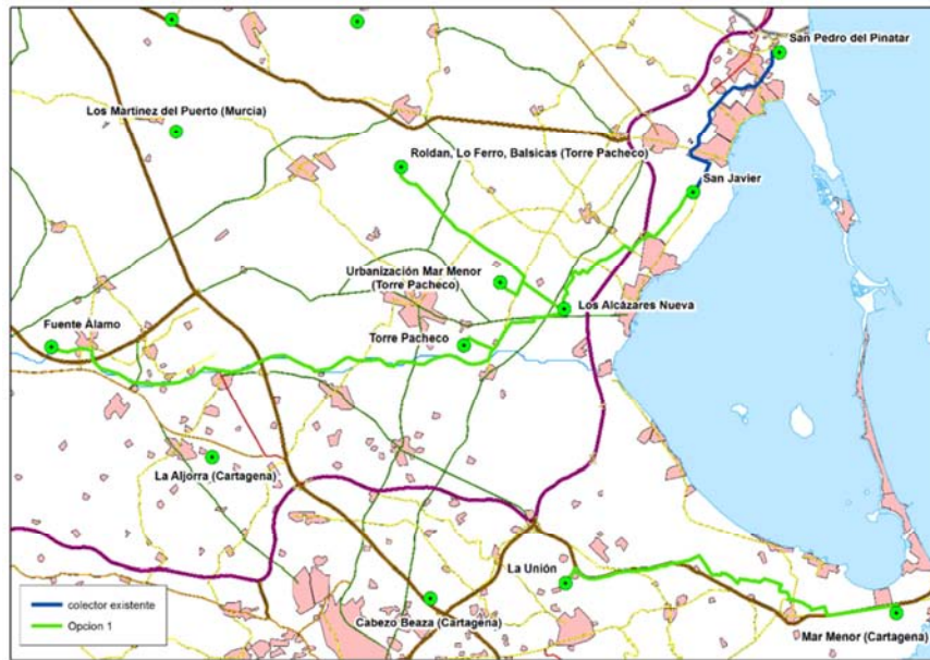
Figura 24: Croquis de las conexiones entre depuradoras
