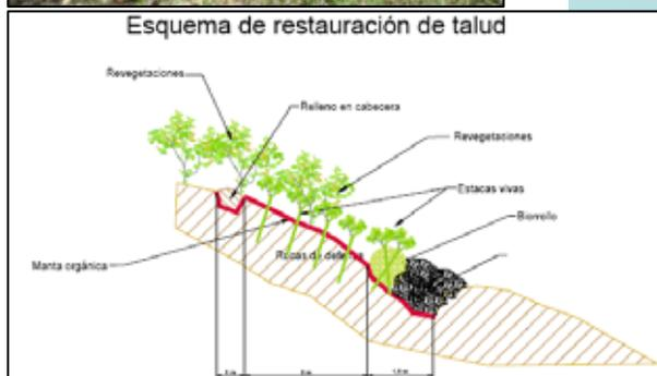
**SOLUCIÓN:** Derribo del azud y restitución del perfil de la margen derecha
