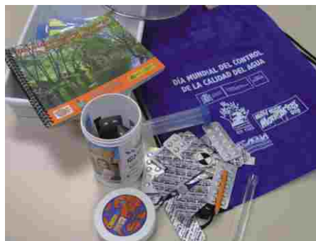
Kit de análisis de la calidad del agua para la medición de parámetros físico-químicos y establecer así unos valores de calidad de agua
