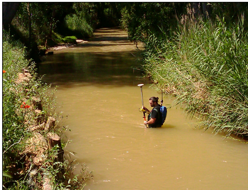
Fotografía 9.- Levantamiento topográfico de cauce para los trabajos de modelización hidráulica y diseño de obras de bioingeniería del río Turia a su paso por el T.M. de Villastar (Teruel). CHJ, junio de 2011.
